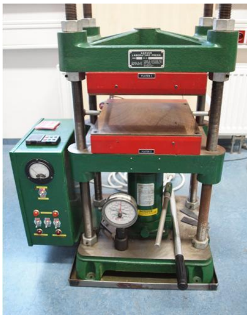
Obr. 9: Hydraulický vytvrzovací lis (Carver Laboratory Press Model 2518).
