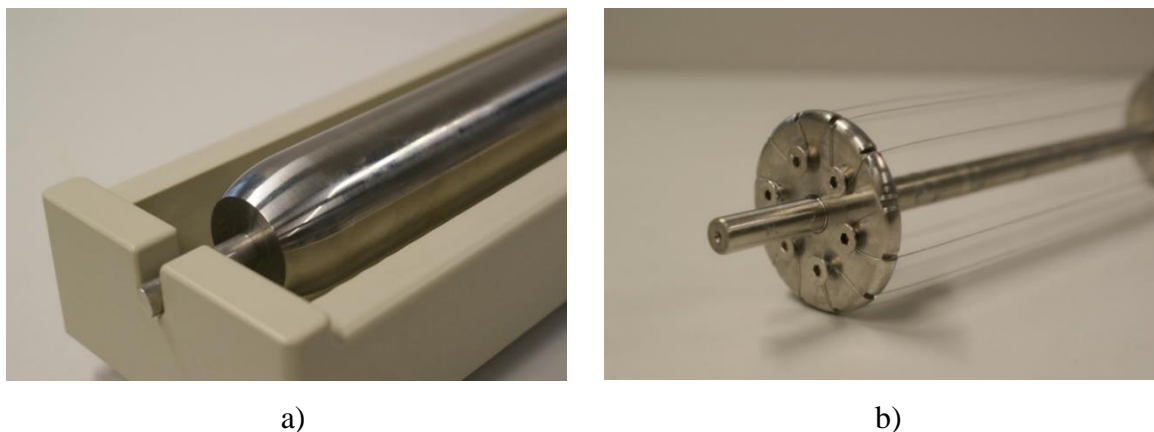
Obr. 4: Ukázka kladné elektrody: a) hladký váleček, b) drátový váleček.
