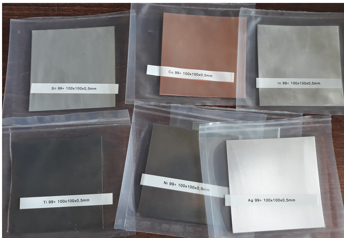
Obrázek 20: Materiály, které se mohou použít pro kalibraci rentgenovou fluorescencí
