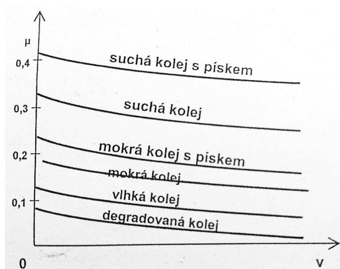
Obr. 6: Porovnání kolejí s rozdílnou adhezí, převzato z [4]
