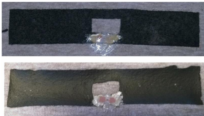
Obr. č. 13: Textilní RFID tagy s grafenovou anténou, GI 1 nahoře, GI 2 dole. Převzato z [40].
