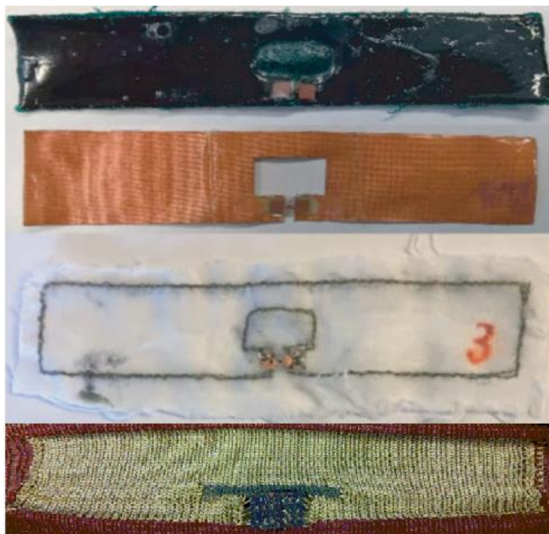
Obr. č. 12: Shora tag natřený vodivou barvou, pod ním tag z elektrotextilie, třetí vyšíváný, dole pletený [37][38].
