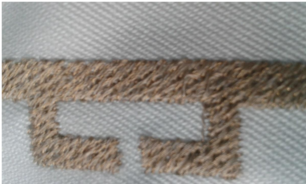
Obr. č. 34: Detail realizované antény textilního RFID tagu vyšitého pomocí šicího stroje Bernina QE750.
