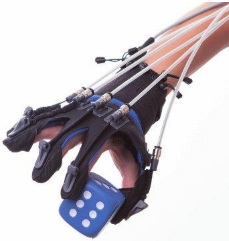
Obr. 23 Zobrazení uchopení předmětu pomocí senzomotorické robotické rukavice Gloreha Sinfonia (převzato z [24]).
