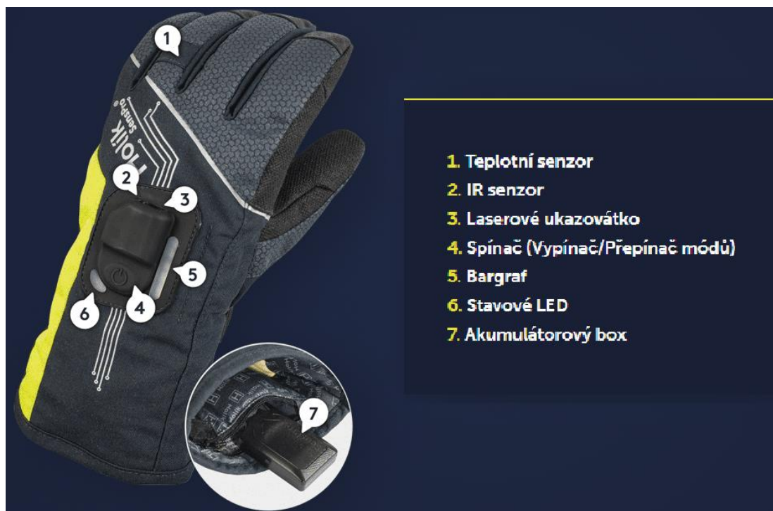
Obr. 12 Zásahové rukavice pro hasiče s implementovanou elektronikou a senzory – textilní – s membránou SensPro® (převzato a upraveno z [9]).
