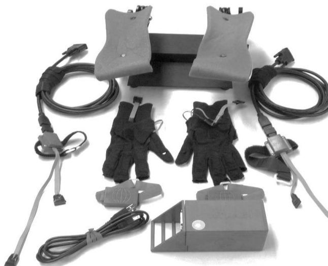
Obr. 4 Sestava pro snímání pohybu celé paže pomocí VR (převzato z [2])
