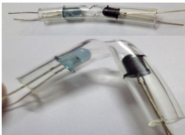
Obr. 6 Diodový senzor snímající ohyb prstu (převzato z [7]).
