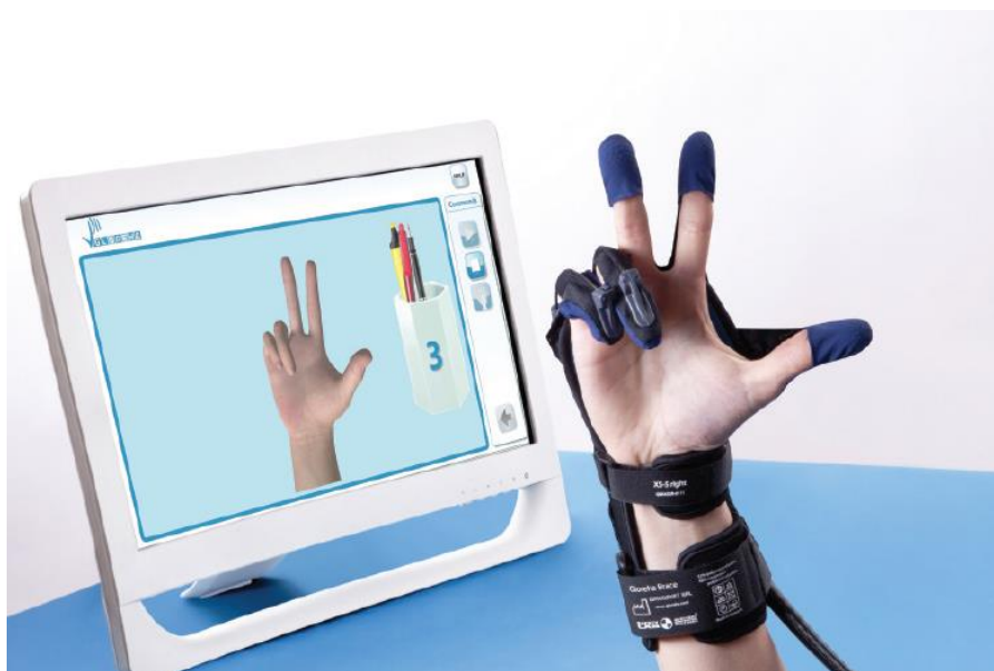
Obr. 24 Vizualizace ruky pomocí softwaru senzomotorické robotické rukavice Gloreha Sinfonia (převzato z [23]).
