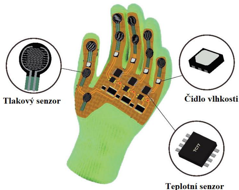
Obr. 11 Umístění senzorů na rukavici (převzato a upraveno z [8]).
