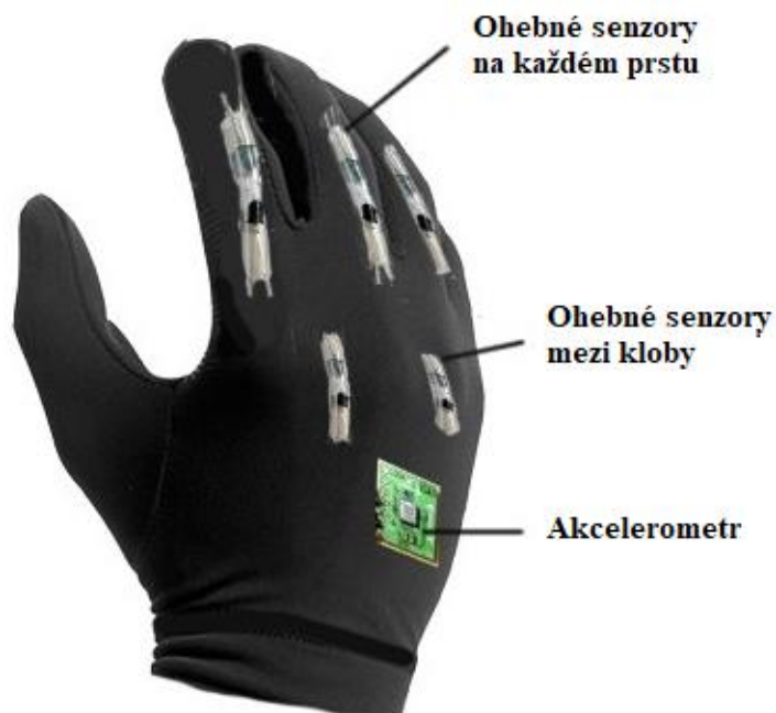
Obr. 7 Rozmístění diodových senzorů a akcelerometru na rukavici (převzato a upraveno z [7]).
