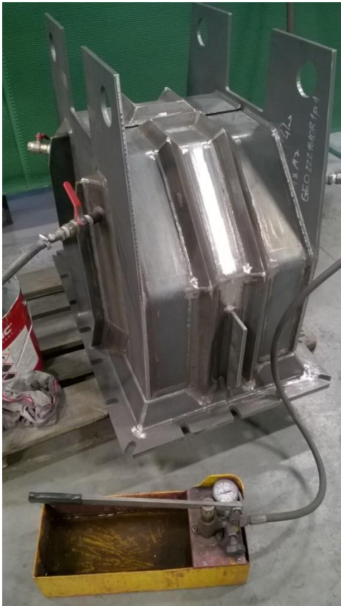
Obr. č. 18: Tlakové zkoušky
