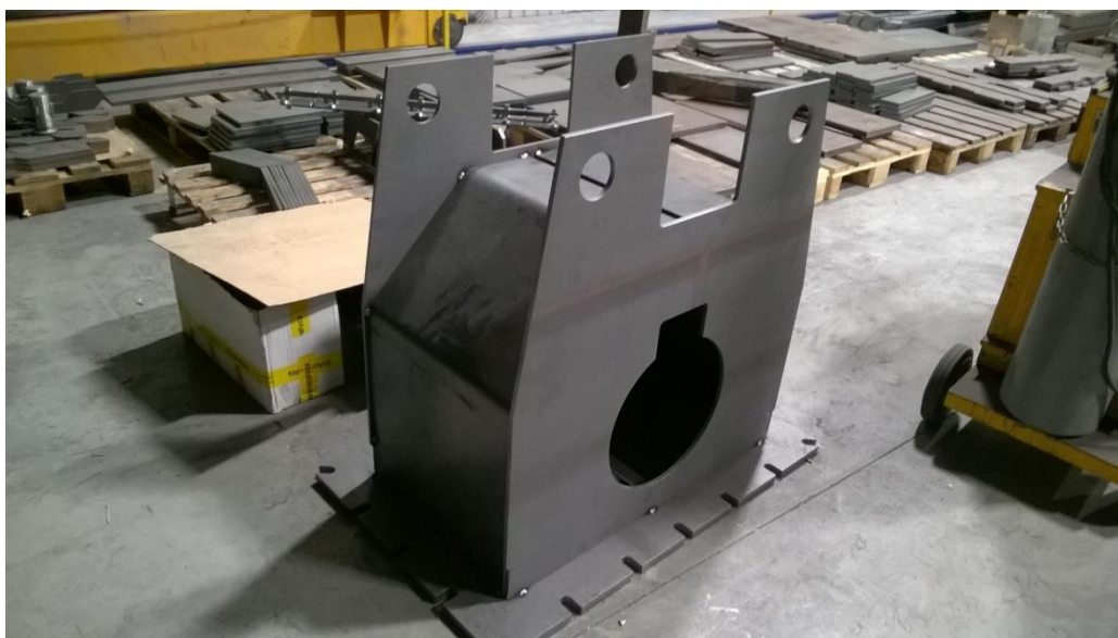
Obr. č. 16: Nastehované těleso indukčního pláště
