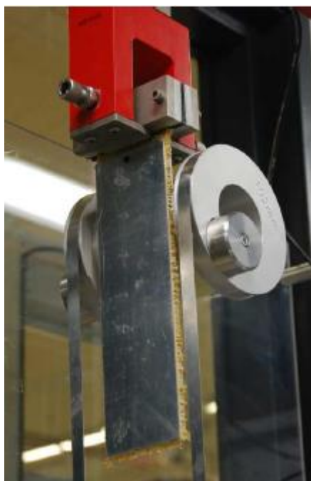
Obrázek 18 - Fotografie zkušební metody navíjení na válec [15]
