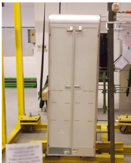
Obrázek 3 - Testování konstrukce sendvičového panelu na zatížení 9G
