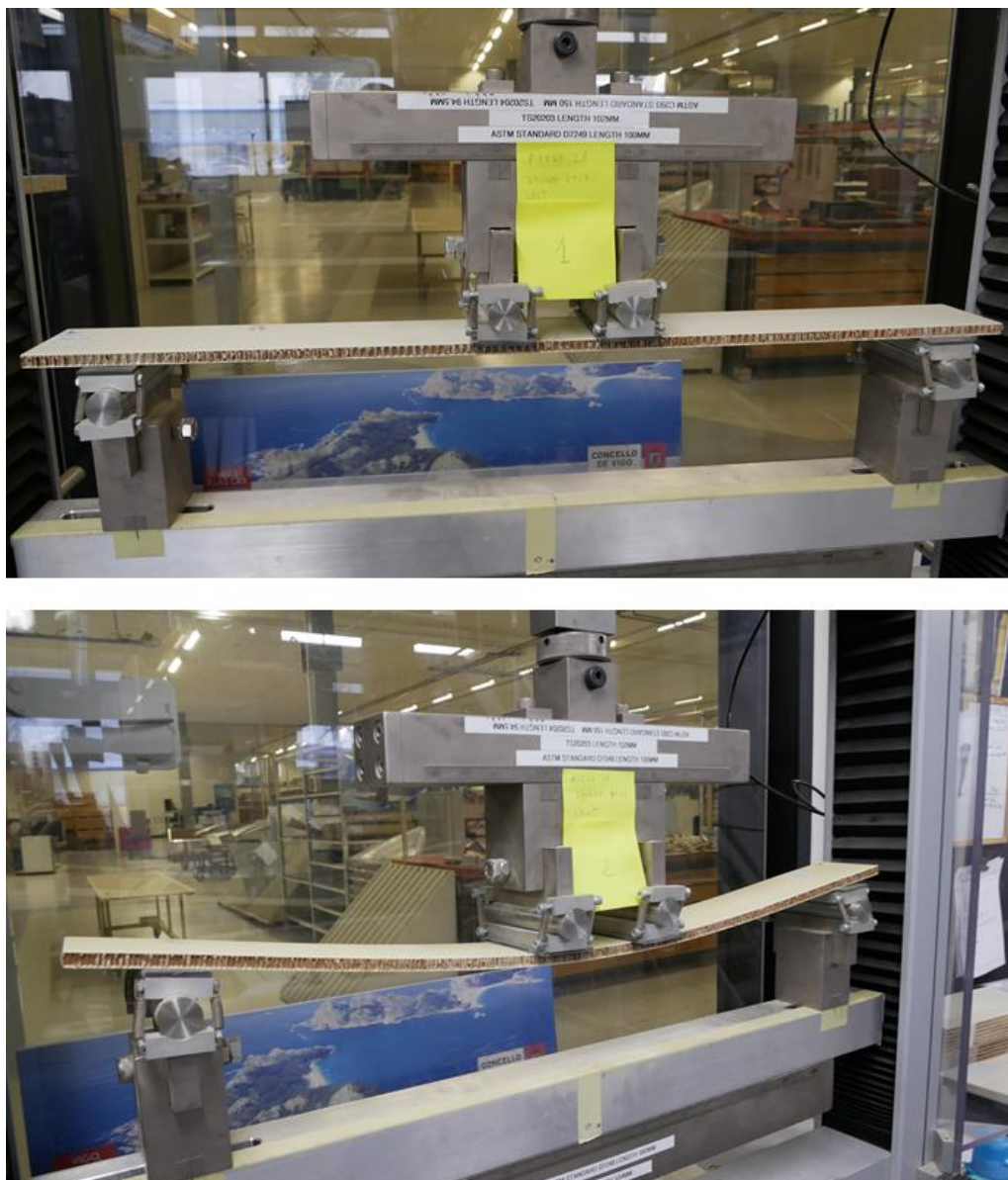
Obrázek 15 - Fotografie zkušební metody čtyřbodovým ohybem
