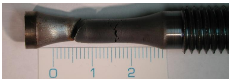
Obr. 14 – vzorek 1.2.2/3 po přetržení
