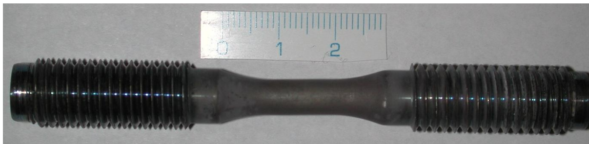
Obr. 12 – zkušební vzorek oceli COST F pro únavové zatěžování
