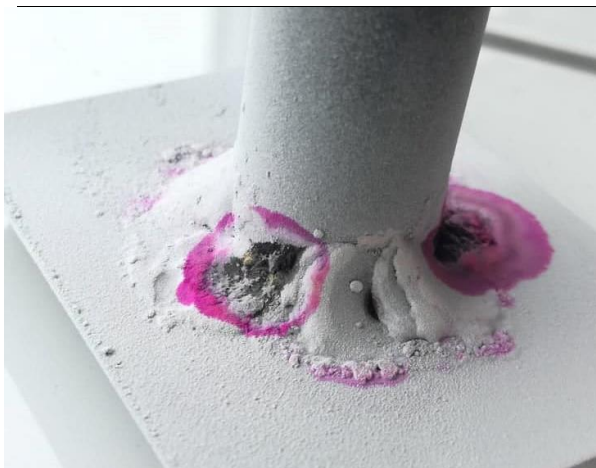
Obr. 31 Vzorek pájený pájkou L – CuZn40 po kapilárním zkoušení
