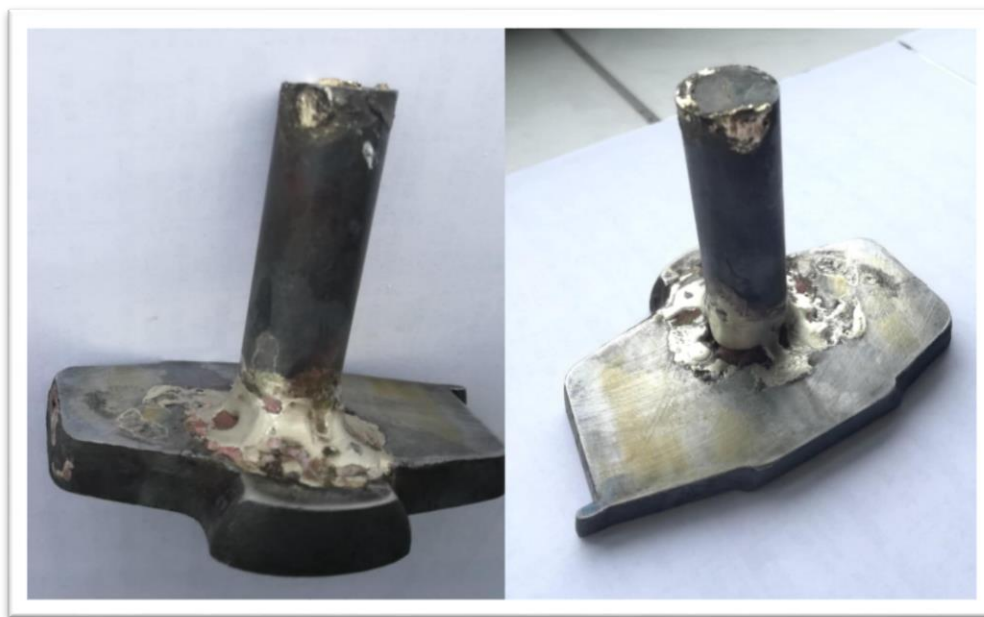
Obr. 29 Fotografie vzorku pájeného pájkou Ag45CuZ
