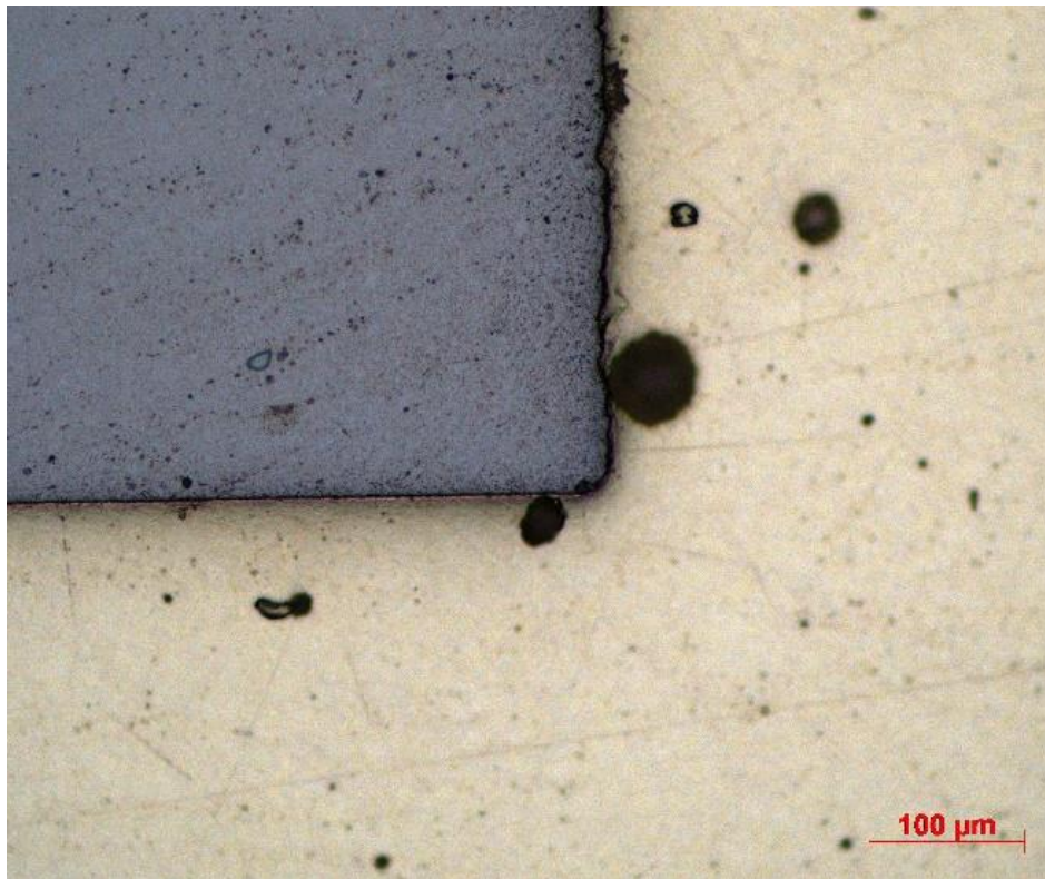
Obr. 39 Mikrosnímek spoje s pájkou Ag45CuZn, rozhraní SK (nahore) – pájka, zvětšení 200x
