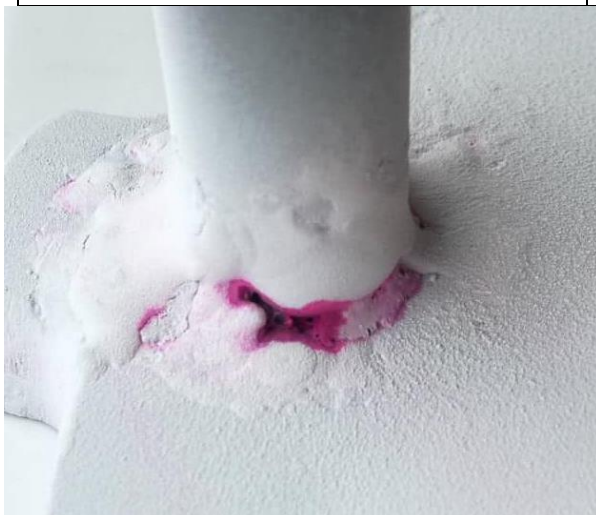
Obr. 33 Vzorek pájený pájkou Ag45CuZn po kapilárním zkoušení
