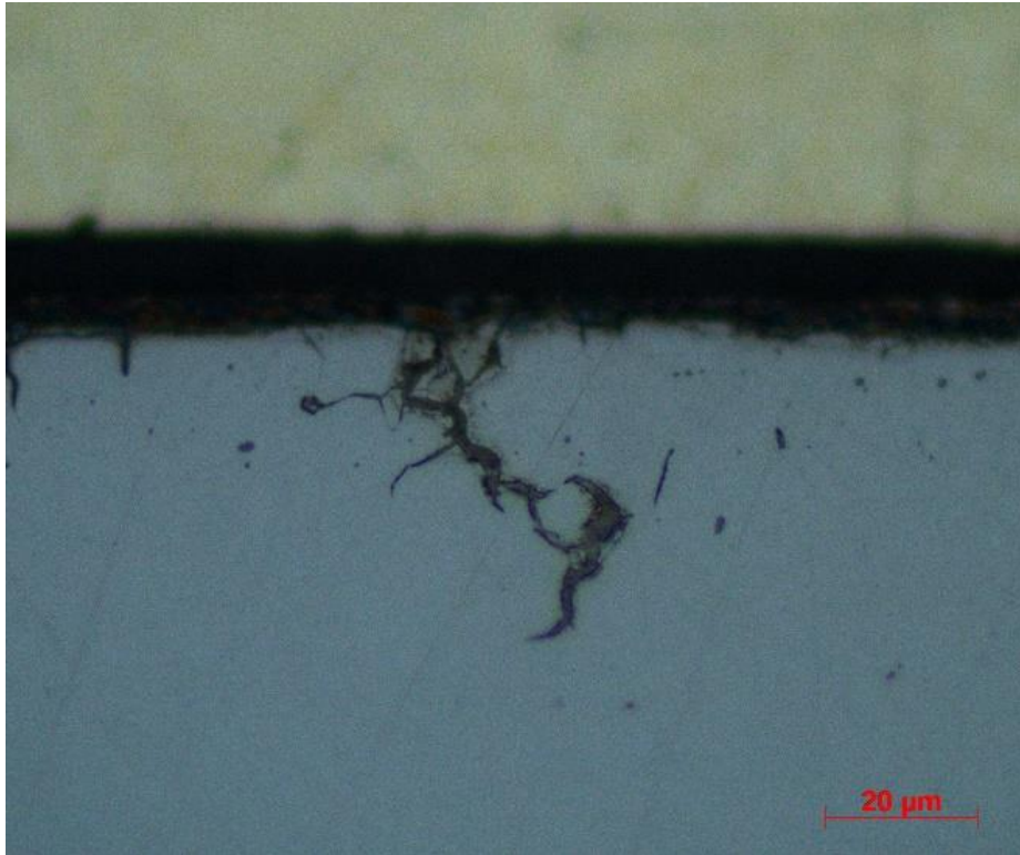
Obr. 41 Mikrosnímek spoje s pájkou Ag45CuZn, rozhraní ocel (dole) – pájka, kde je viditelná trhlina, zvětšení 1000x
