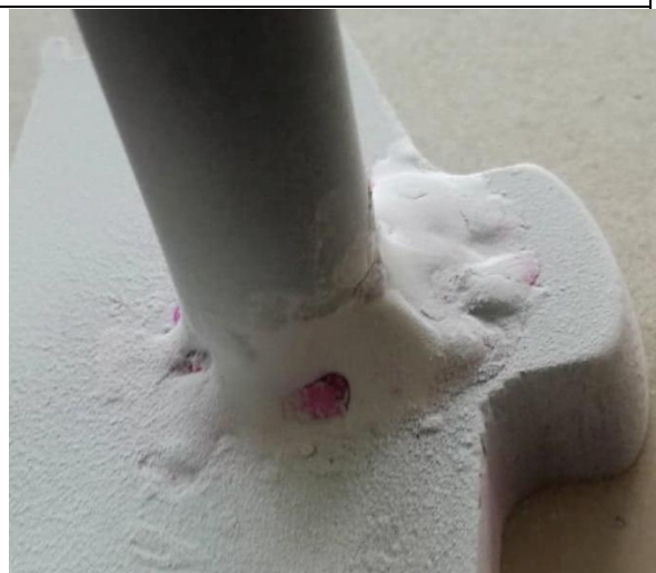
Obr. 34 Vzorek pájení pájkou Ag45CuZn po kapilárním zkoušení
