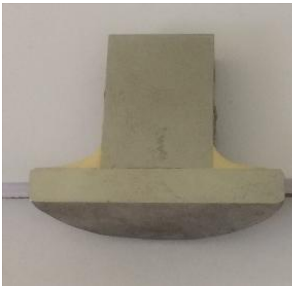
Obr. 21 Řez pájeného spoje
