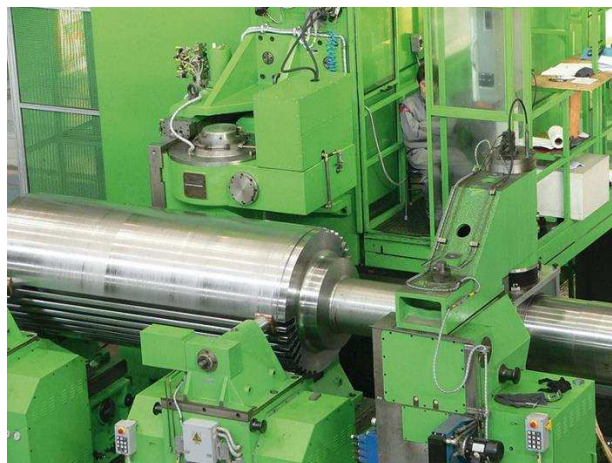
Obrázek 24: Obrábění rotoru turboalternátoru [12]
