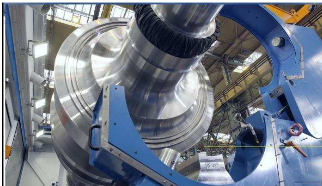
Obrázek 8: Opěra s tlakovým přívodem oleje [16]
