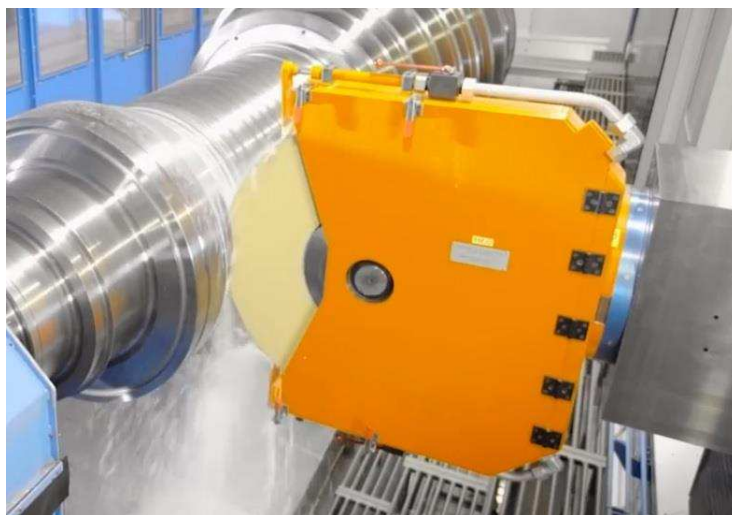
Obrázek 19: Broušení rotoru turbíny [16]
