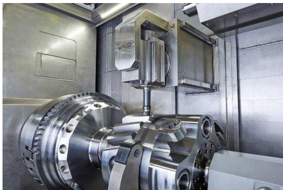
Obrázek 38: Soustružnicko – frézovací nevýměnná hlava [26]
