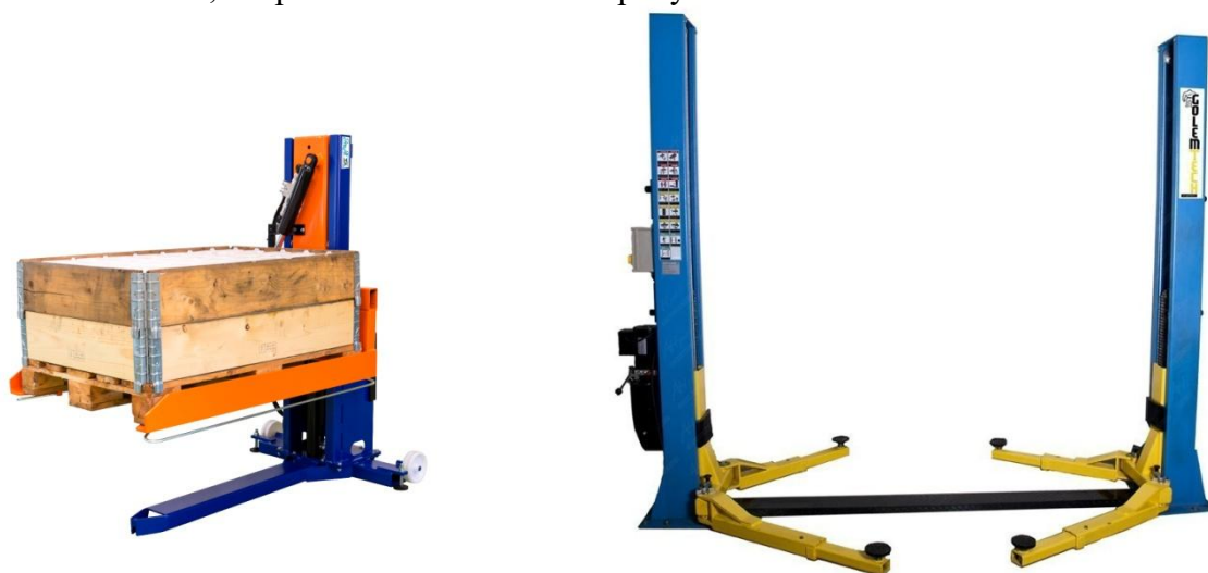
Obr. 5-4 Sloupová plošina pro zdvihání palet (vlevo) a sloupový zvedák pro zdvihání automobilů (vpravo) [26]
