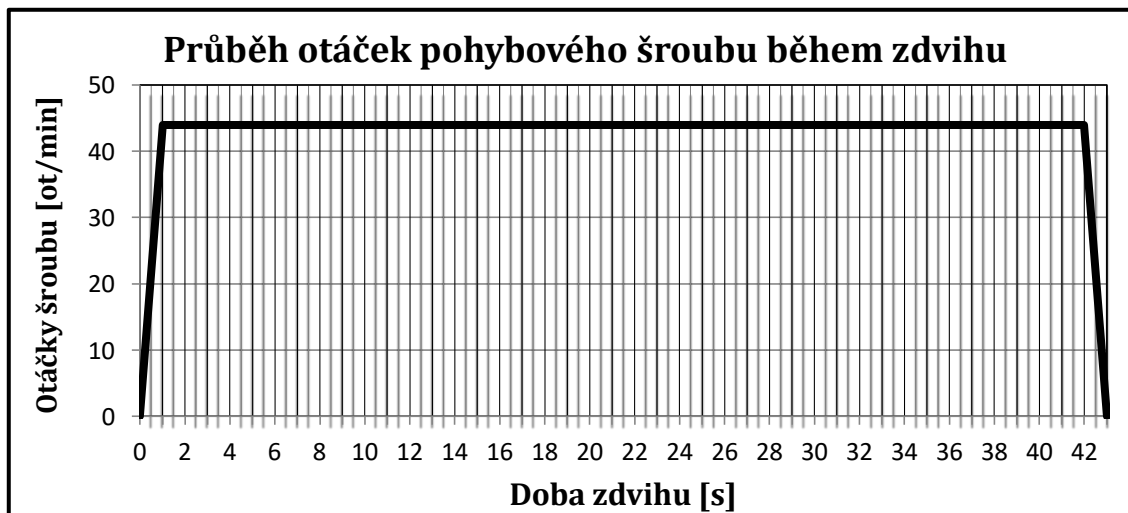
Obr. 8-47 Grafické zobrazení předpokládaného průběhu otáček pohybového šroubu během zdvihu
