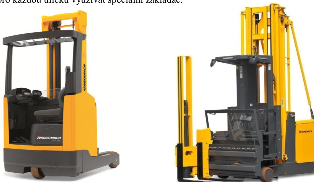
Obr. 4-13 Srovnání skladového VZV (vlevo) a regálového zakladače (vpravo) [21]
