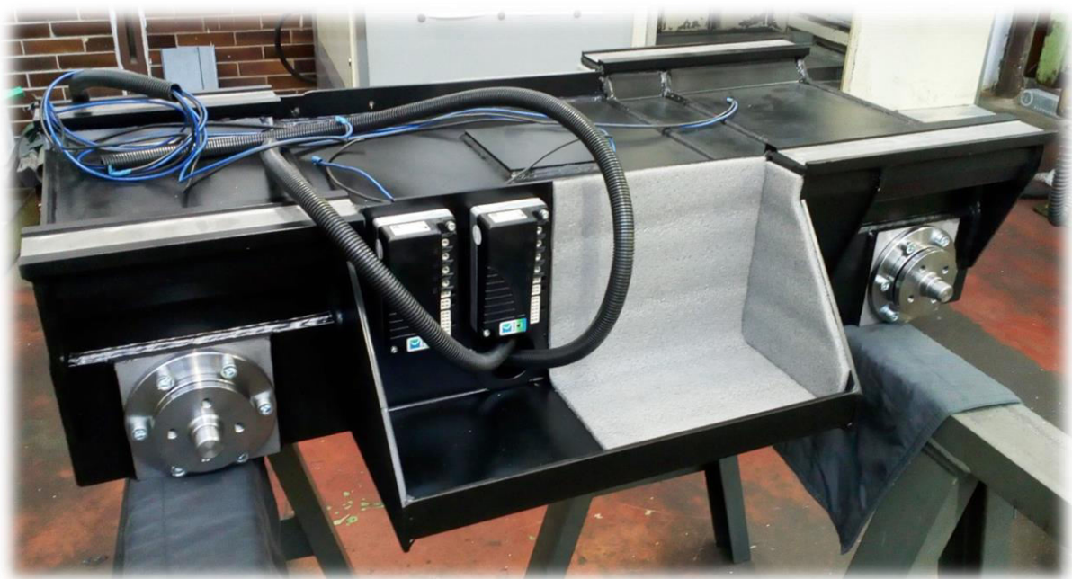
Obr. IV Boční pohled na rám podvozku po instalaci pohonu
