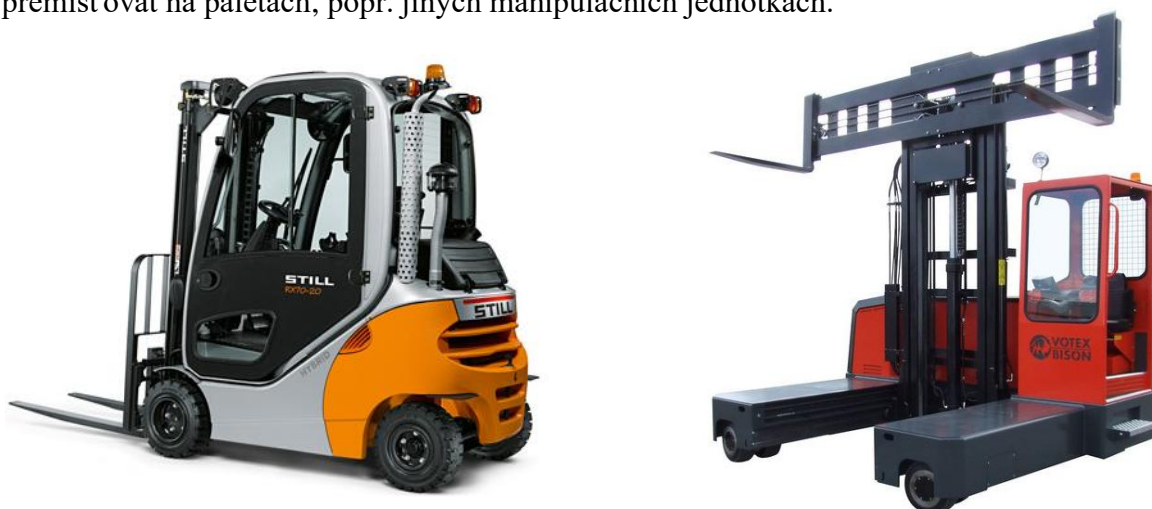
Obr. 4-12 Rozdíl mezi čelním dieselovým VZV (vlevo) a bočním akumulátorovým VZV (vpravo) [20]
