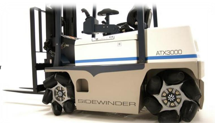
Obr. 9-4 Ukázka vysokozdvizného vozíku osazeného koly typu "Omni wheel" [47]
