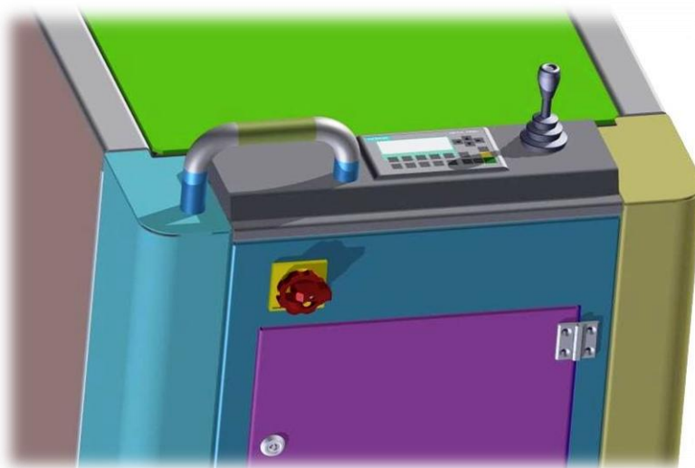
Obr. 10-12 Navržené rozmístění ovládacích prvků v zadní části vozíku
