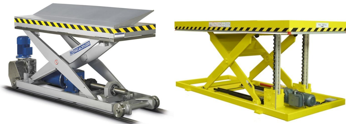
Obr. 5-8 Nůžková plošina s pohonem pomocí pohybového šroubu a matice (vlevo) a pomocí tažných/tlačných řetězů (vpravo)[30]
