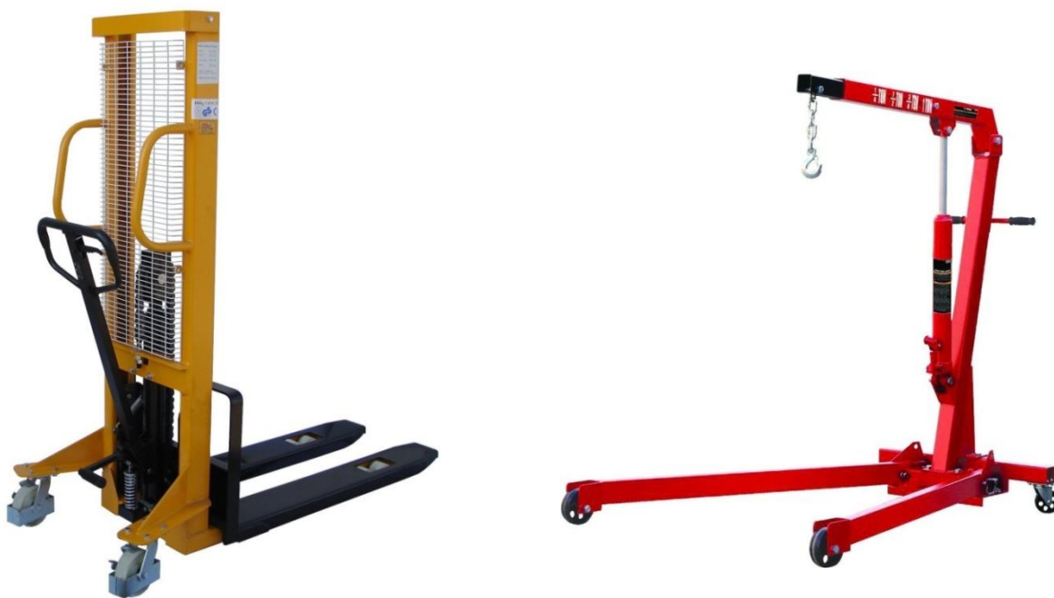
Obr. 4-5 Ruční vysokozdvihný vozík (vlevo) a dílenský jeřáb (vpravo) [13]
