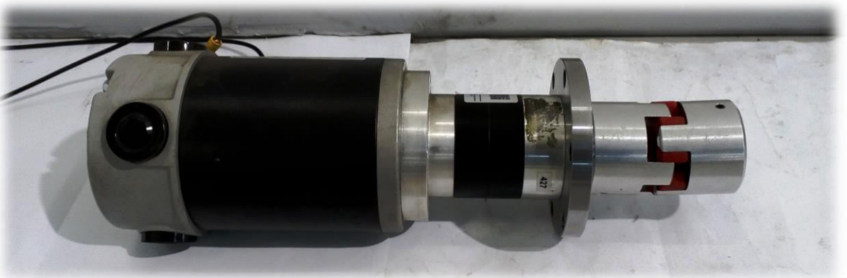
Obr. VI Sestava elektromotoru, planetové převodovky a pružné bezvúlové spojky určená pro pohon zdvižného mechanismu
