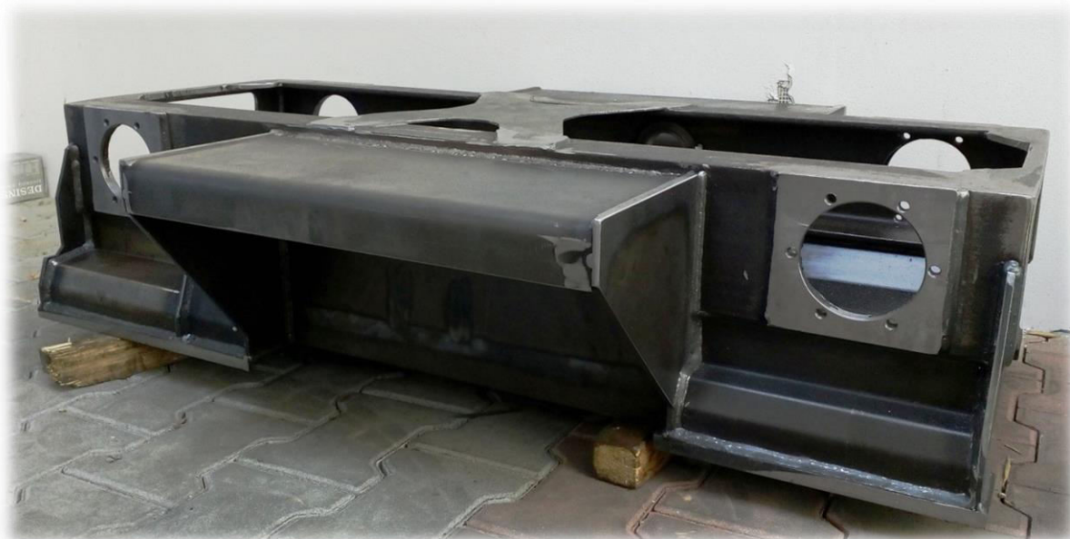
Obr. I Rám podvozku (spodní strana) po svaření a opracování funkčních ploch
