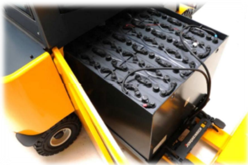
Obr. 4-8 Umístění akumulátoru ve vysokozdvizném vozíku [16]
