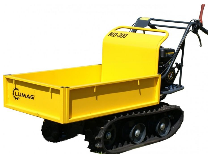
Obr. 2-1 Příklad motorového dopravního vozíku pro přepravu sypkých materiálů [8]
