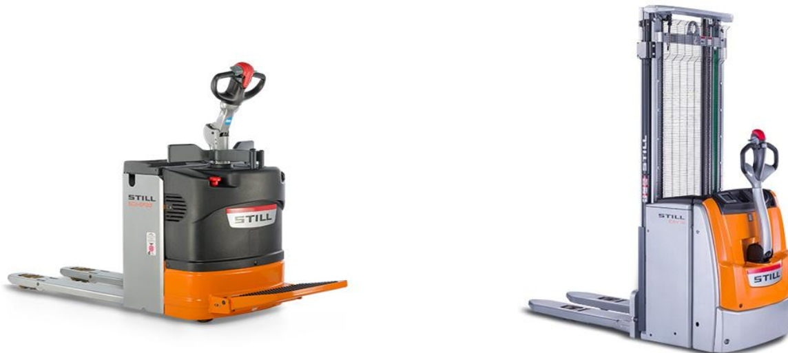
Obr. 4-11 Nízkozdvížený vozík pro stojící obsluhu (vlevo) a vysokozdvížený vozík pro kráčeující obsluhu (vpravo) [19]
