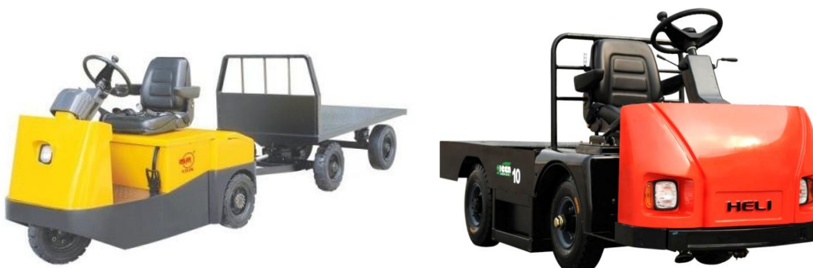
Obr. 4-10 Srovnání motorového tříkolového tahače (vlevo) a čtyřkolového plošinového vozíku (vpravo) [18]
