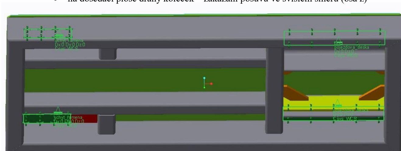
Obr. 11-7 Zobrazení oblastí s definovanou vazbou na spodní části plošiny
