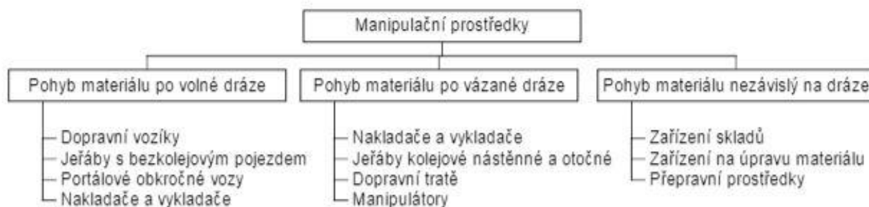
Obr. 1-3 Rozdělení manipulačních prostředků podle vazby k dráze [4]
