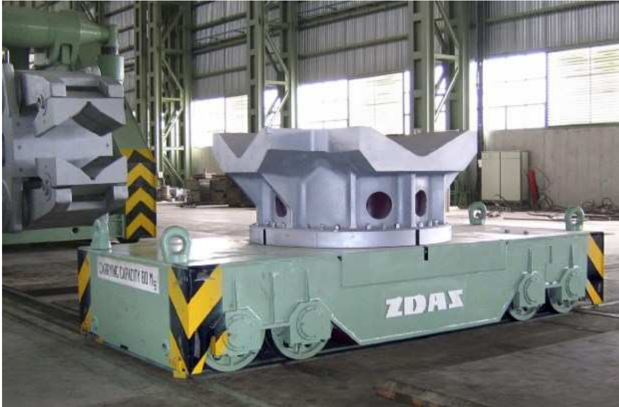
Obrázek 10 - Ingotový vůz QHK Žďas [11]
