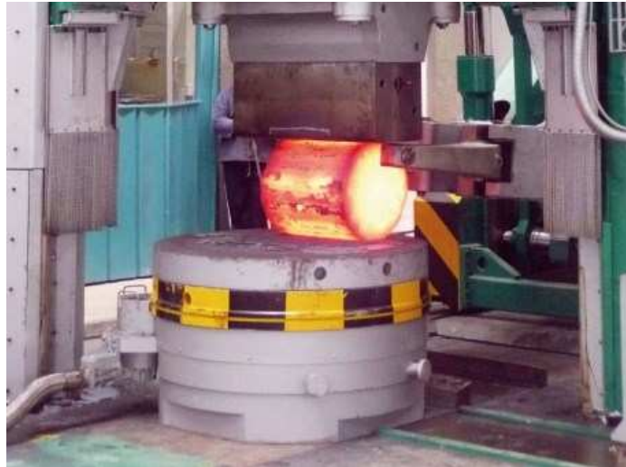
Obrázek 12 - Otočný kovací stůl QWK [11]
