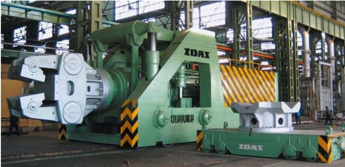
Obrázek 9 - Kolejový kovací manipulátor Žďas [8]
