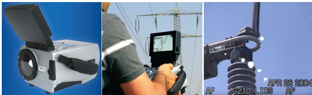
Obr. 3.11: Kamera DayCorSUPERB a její použití. [Převzato z [31]]
