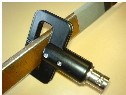
Obr. 3.9: Induktivní senzor pro měření částečných výbojů. [Převzato z [26]]
