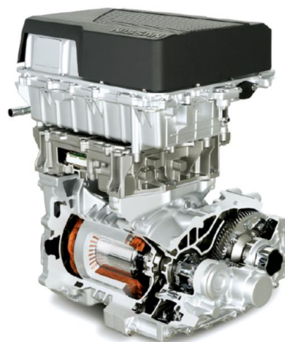
Obr. 1.4 Nissan Leaf - Motor a výkonový obvod, převzato z [8]:
