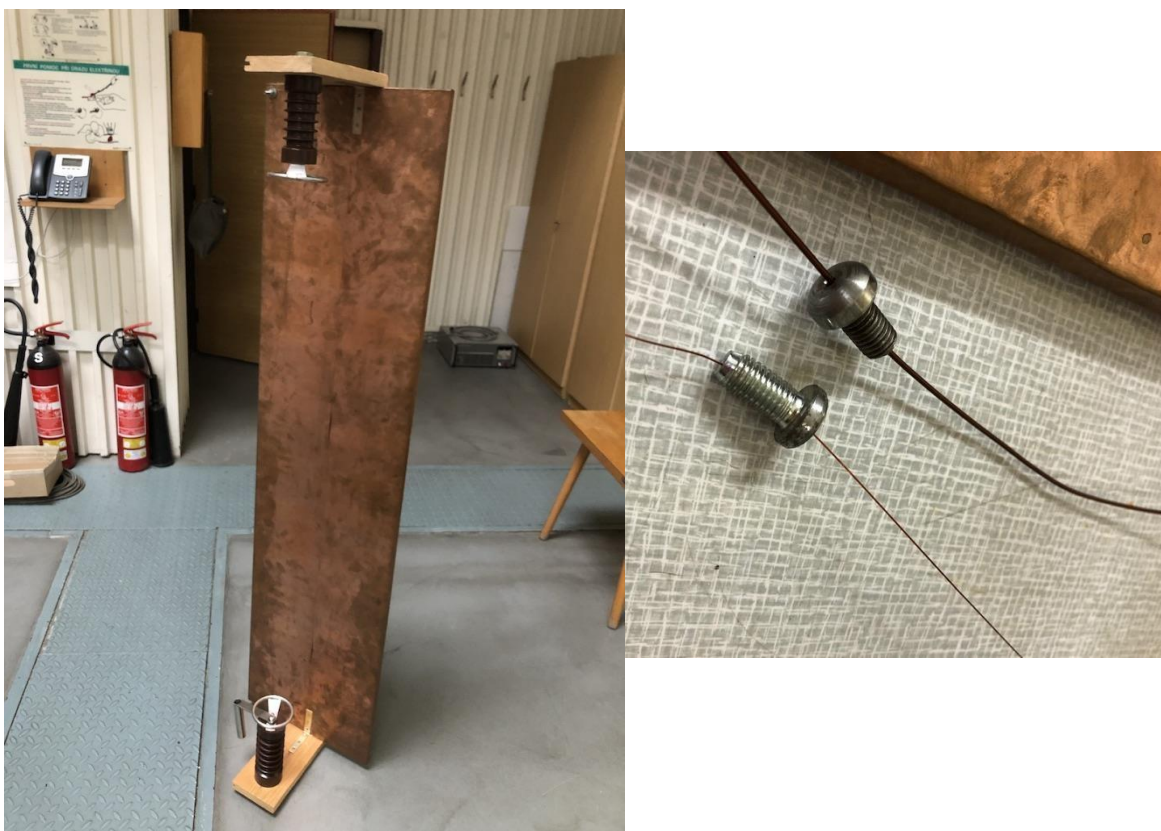
Obr. 4.3 Model venkovního vedení pro měření koróny ZČU, KEE
