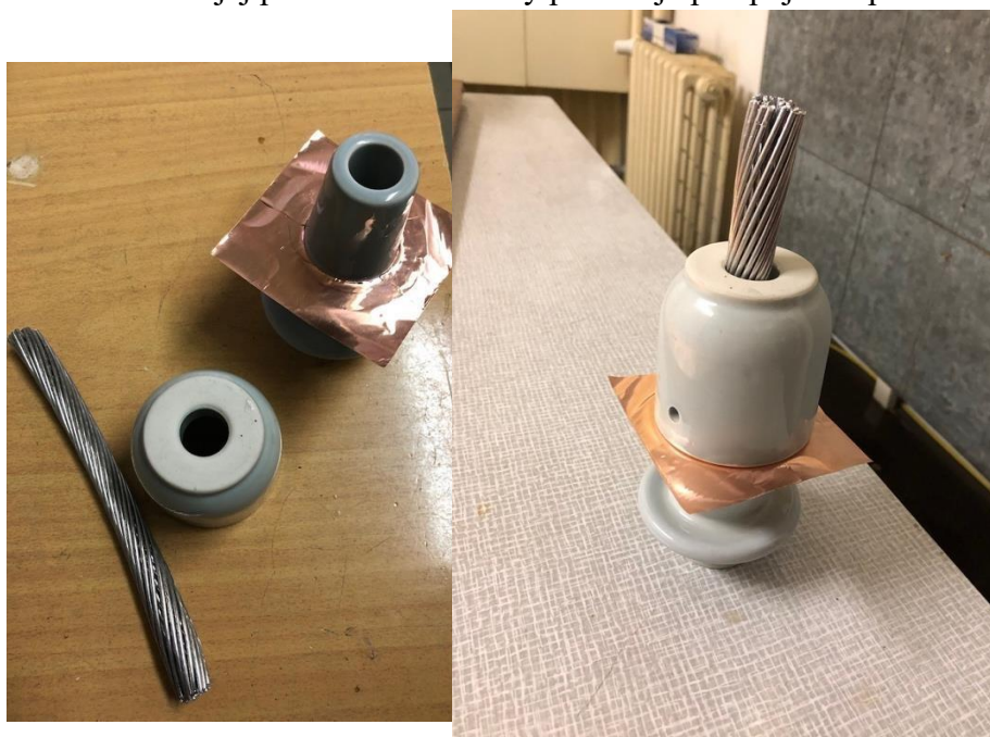
Obr. 4.5 Zhotovený model – rozebraný (vlevo) a poloha stojící, která byla použita i pro měření (vpravo)
