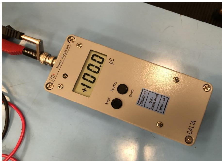
Obr. 3.6 Kalibrátor s typovým označením CAL1A, ICMsystem při kalibrování na použitých 100 pC pro experimentální měřící obvod
