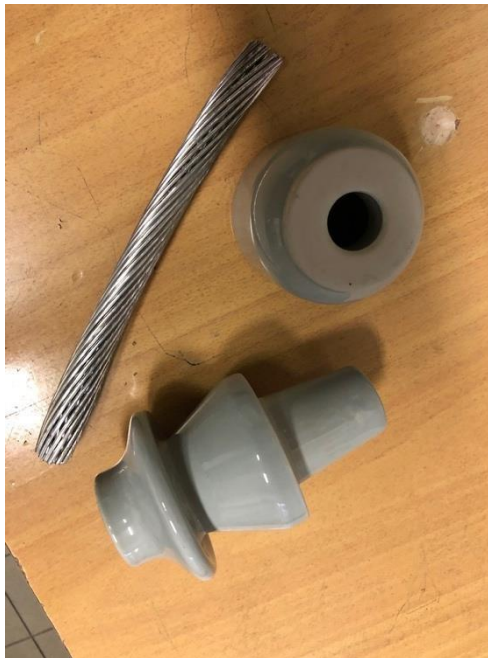
Obr. 4.4 AlFe lano společně s keramickým tělem průchodky před vyhotovením
