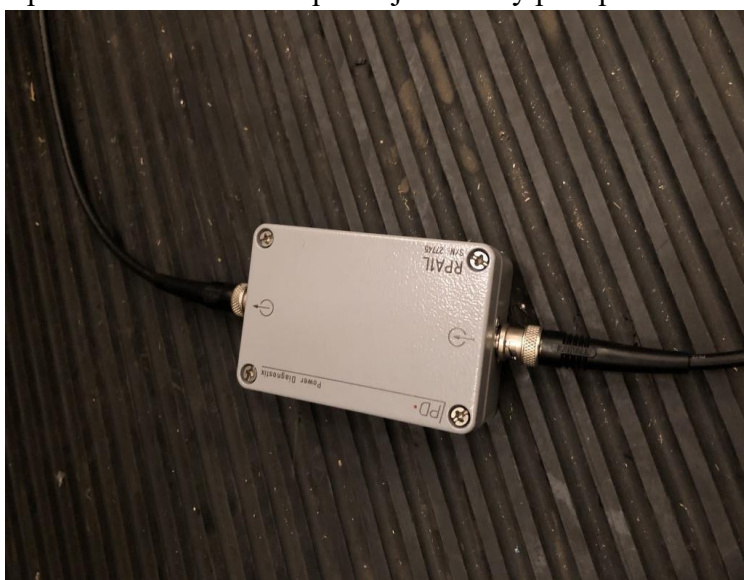
Obr. 3.4 Fotka signálního před-zesilovače RPA1L
