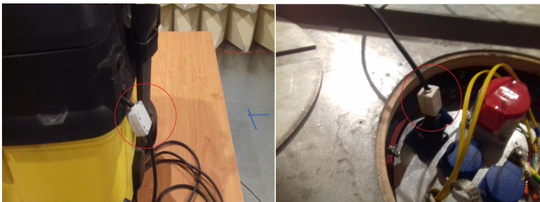
Obr. 4.3 Ferit na začátku (vlevo) i na konci vedení (vpravo)
