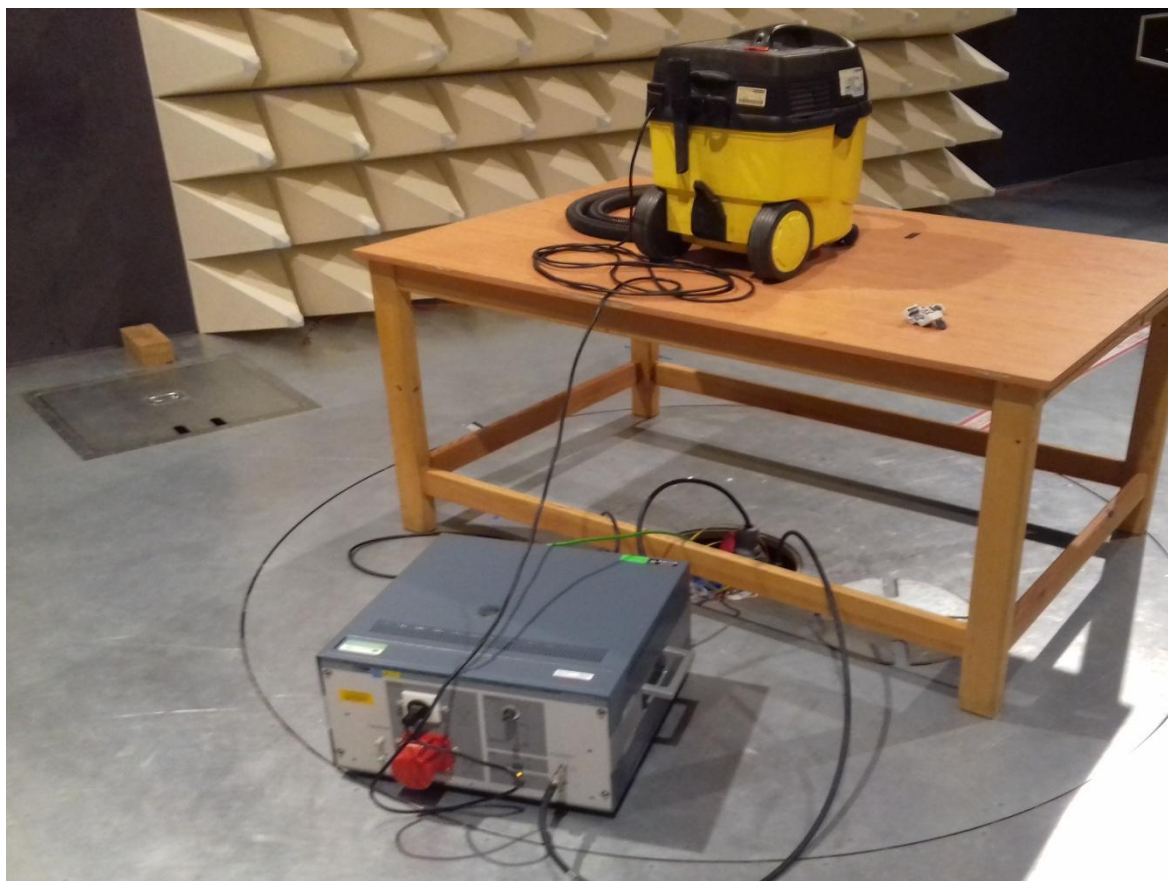
Obr. 4.7 Skutečné uspořádání zkušebního stanoviště pro měření konduktivních emisí
