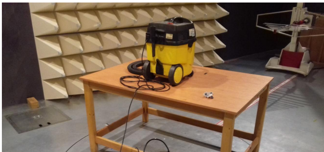
Obr. 4.2 Skutečné uspořádání zkušebního stanoviště pro měření vyzařovaných emisí
