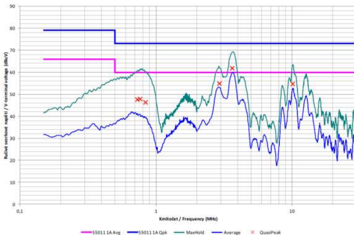
Obr. 37 – Frekvenční charakteristika rušivého svorkového napětí ve vodiči N [23]
