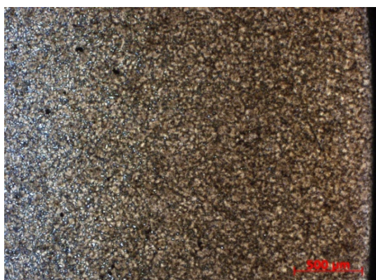
Obr. 3.9.1 Mikrostruktura kalené vrstvy Zvětšení 25x [12]
