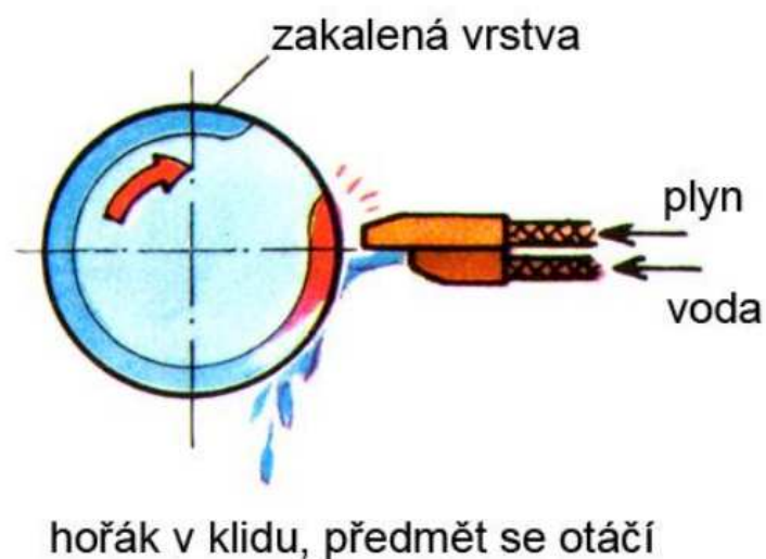
Obr. 1.1 Povrchové kalení plamenem [14]
