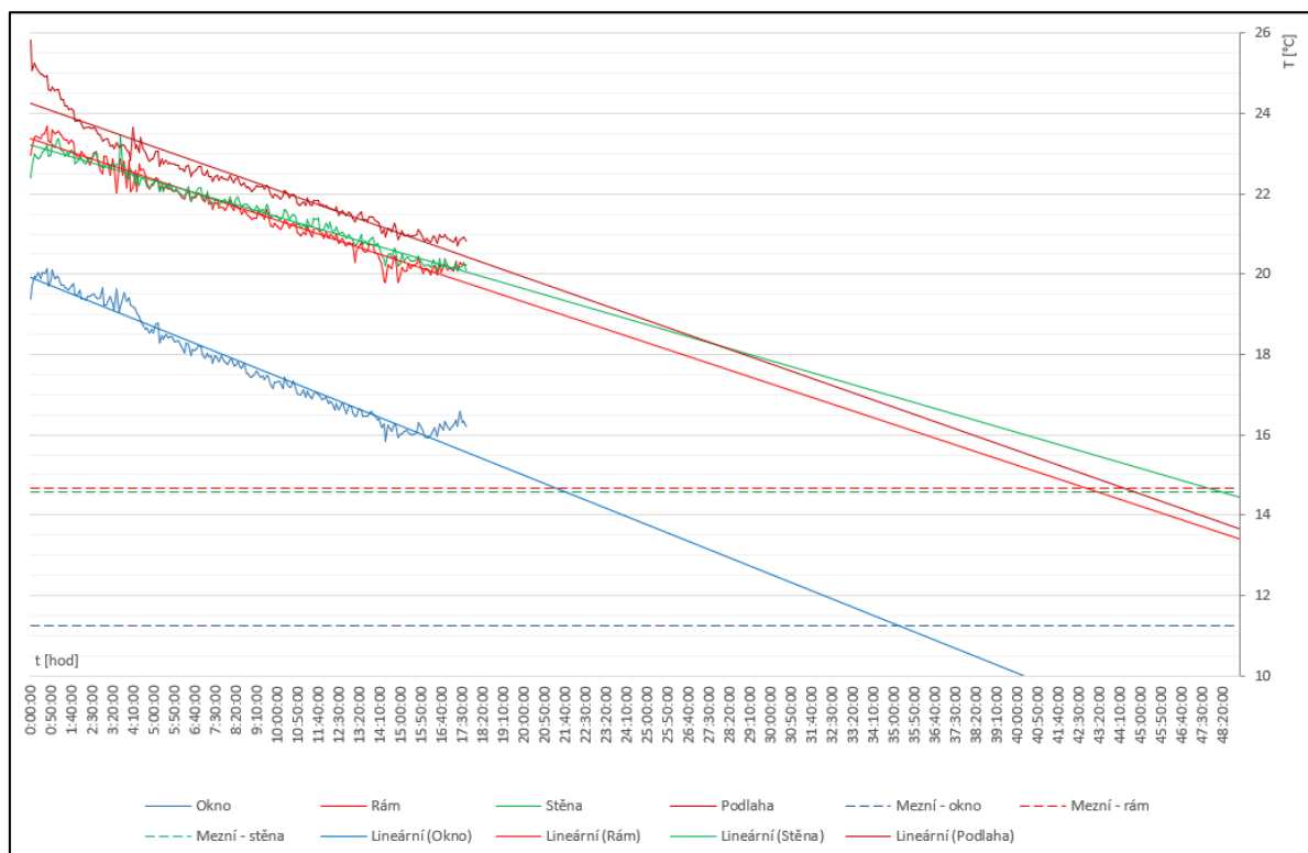
Graf 8: Odhad chladnutí konstrukce
