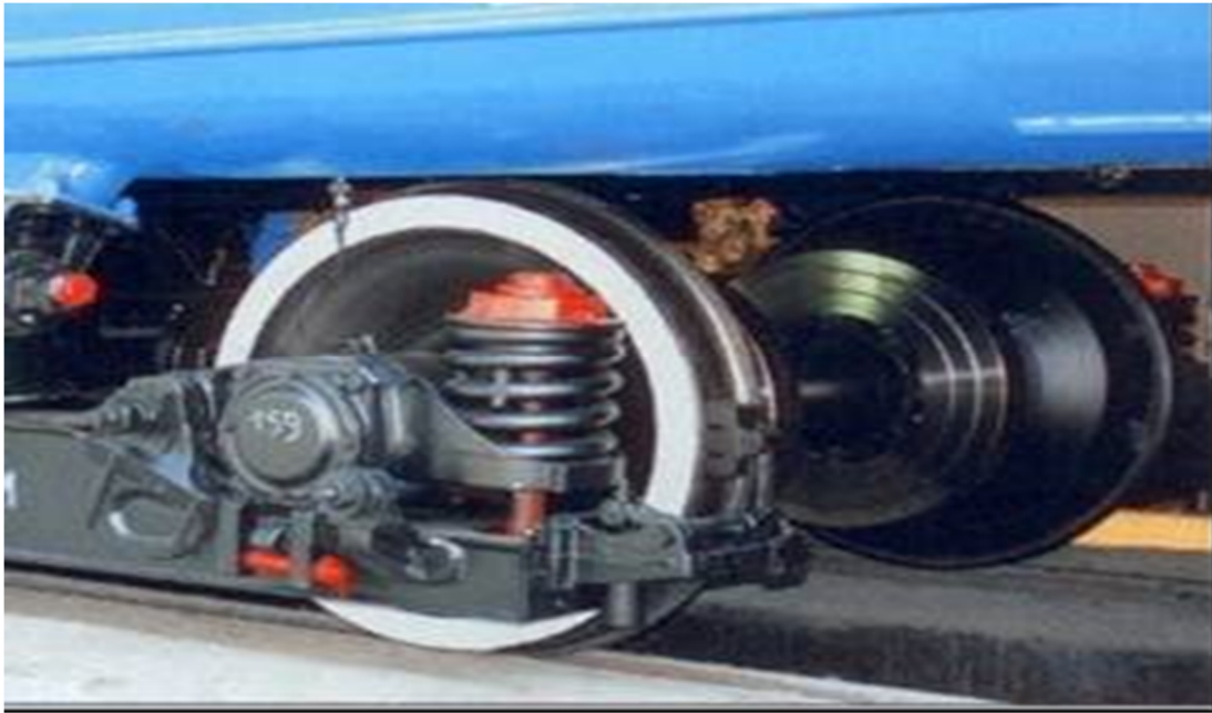
Obrázek 11 Vedení převráceným kyvným ramenem – převzato z [12]
