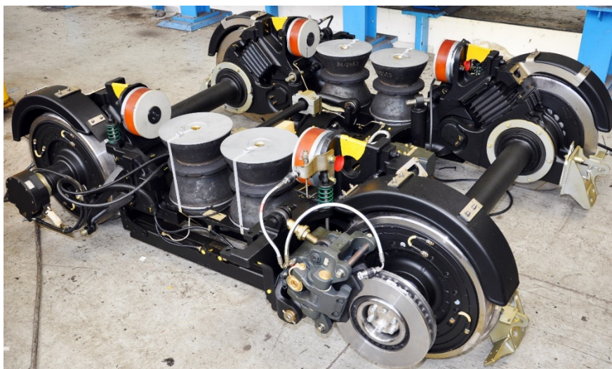
Obrázek 19 Podvozek Flexx – Urban 3000 – Primární vypružení a vedení dvojkolí kyvným ramenem [20]
