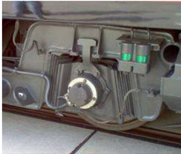
Obrázek 5 Vedení dvojkolí šipovými pružinami MEGI – převzato z [12]
