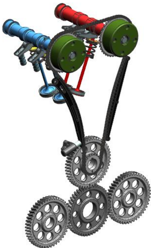
Obr. 39 - ventilový rozvod (předek)
