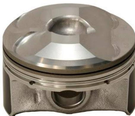
Obr. 3 - výduť v pístu [5]
