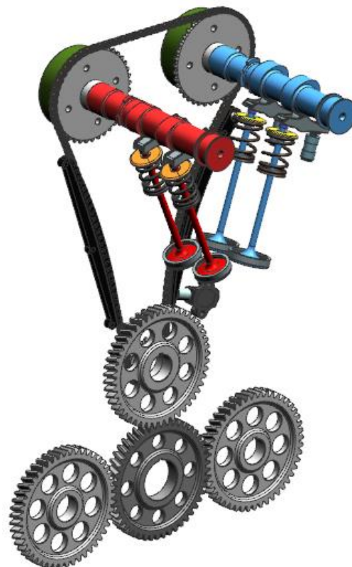
Obr. 40 - Ventilový rozvod (zadek)
