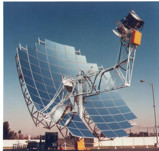
Obrázek 11 – Paraboloidní koncentrátor s energetickou konverzní jednotkou [16]
