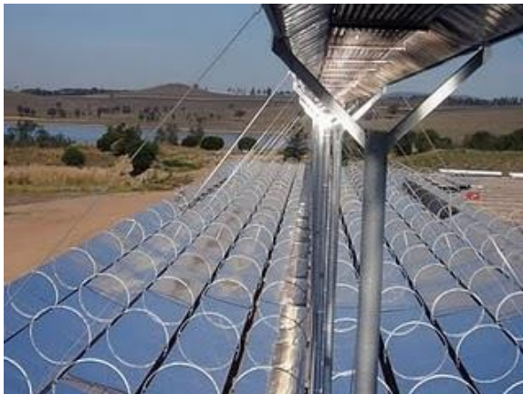
Obrázek 8 – Koncentrátor složený z rovinných zrcadel (Fresnelův lineární koncentrátor) [13]
