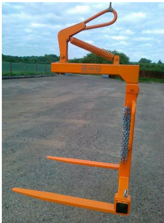
Obrázek 19 - Samovyvažovací paletové vidle (7)
