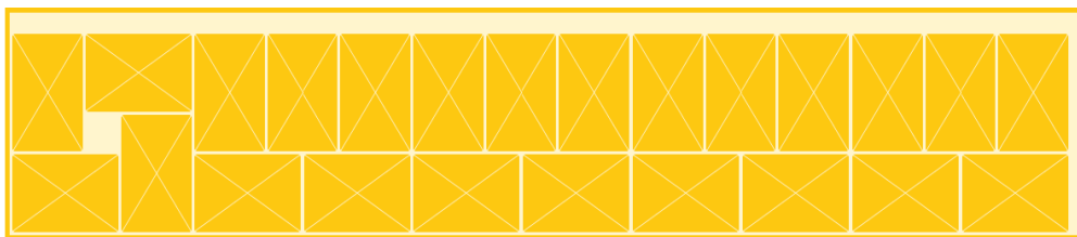
Obr. č. 10: Způsob uložení palet v kontejneru dle DHL
