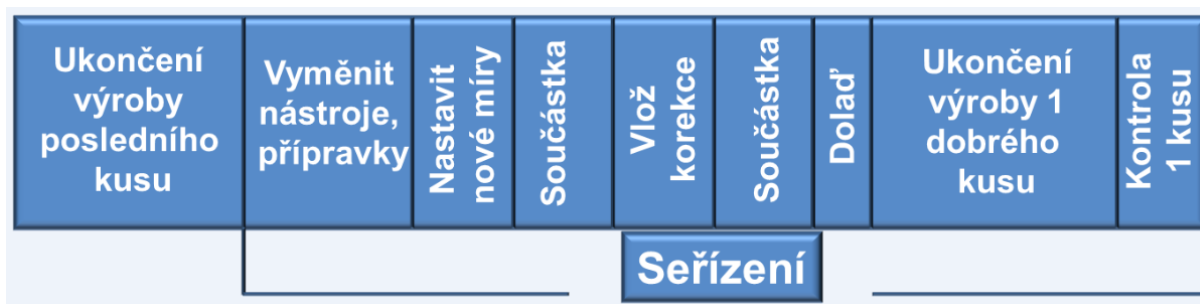
Obrázek 6 - Obecné schéma úkonů přestavby stroje [14]
