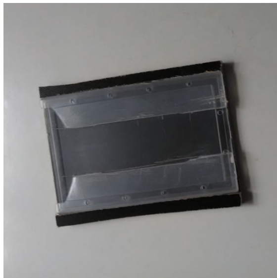
Obr. 33 Přípravek k uchycení vzorku pro zkoumání světelným mikroskopem
