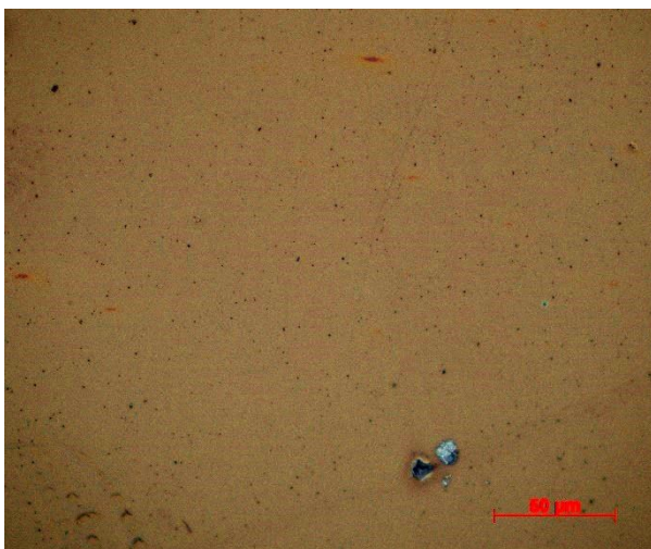
Obr. 22 Vzorek 141-45 ohyb přes průměr 4 mm – zvětšeno 500x: nenalezeny žádné lomové čáry
