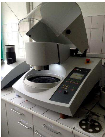
Obr. 14 Metalografická bruska/leštička Struers Tegramin 30 (vlevo); Obr. 15 Světelný mikroskop Zeiss Axio Lab. A1 (vpravo)
