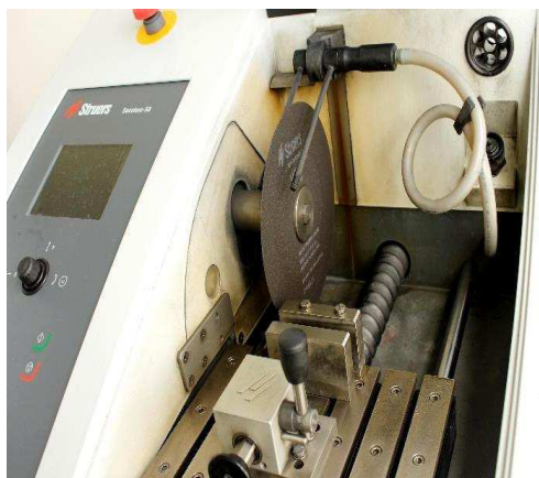
Obr. 12 Metalografická pila Struers Secotom 50; Obr. 13 Zalévací lis Struers CitoPress 10
