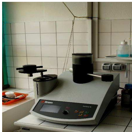
Obr. 12 Metalografická pila Struers Secotom 50; Obr. 13 Zalévací lis Struers CitoPress 10
