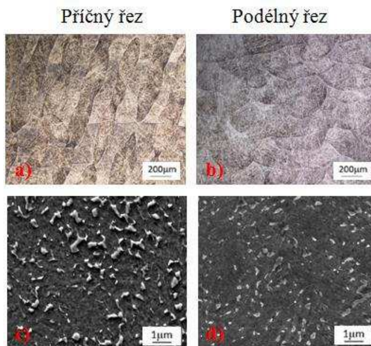
Obr. 43 Mikrostruktury aditivně zpracované maraging oceli – vytvrzený stav: 43 a) a 43 c) příčný řez, světelná a řádkovací elektronová mikroskopie; 43 b) a 43 d) podélný řez, světelná a řádkovací elektronová mikroskopie
