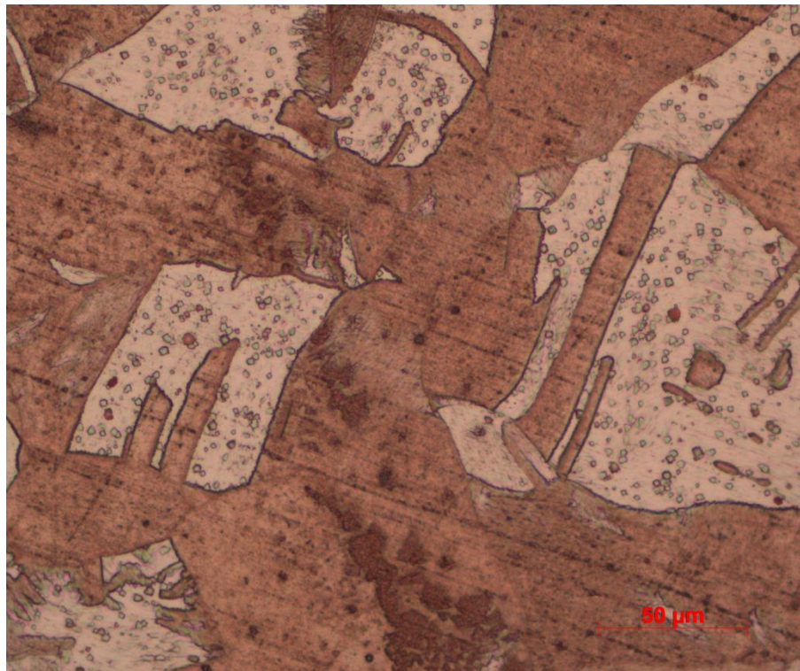
Obr. 29 Vzorek mědi, zvětšeno 500 \times , leptáno 40 s v roztoku 30 ml HCl, 10 g FeCl 3 a 120 ml etanolu
