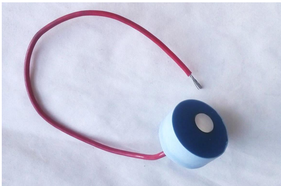
Obr. 32. Vzorek zalitý do hmoty Dentacryl s vybroušenou kruhovou plochou
