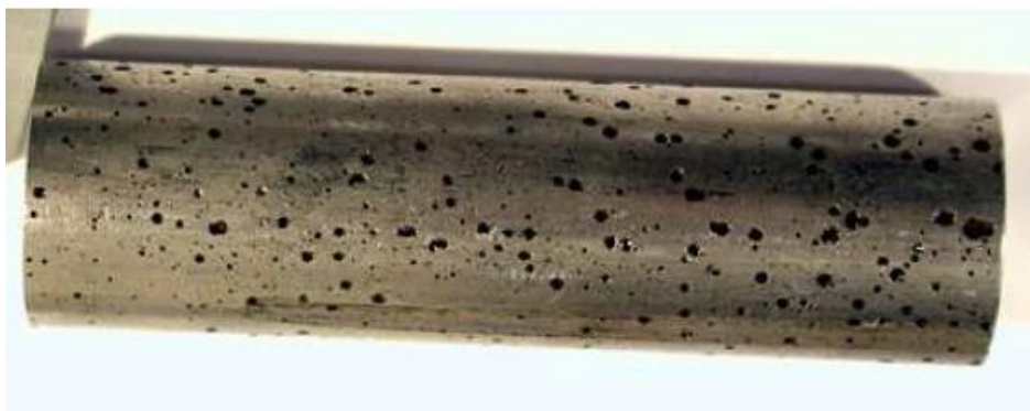
Obr. 6 Bodové napadení trubky z korozivzdorné oceli [17]
