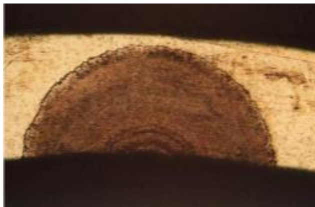
Obr. 8 Lokální odzinkování mosazi ve vodě – příčný řez [17]
