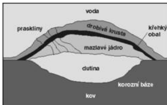
Obr. 11 Vznik pittingu při aerobní korozi [1]
