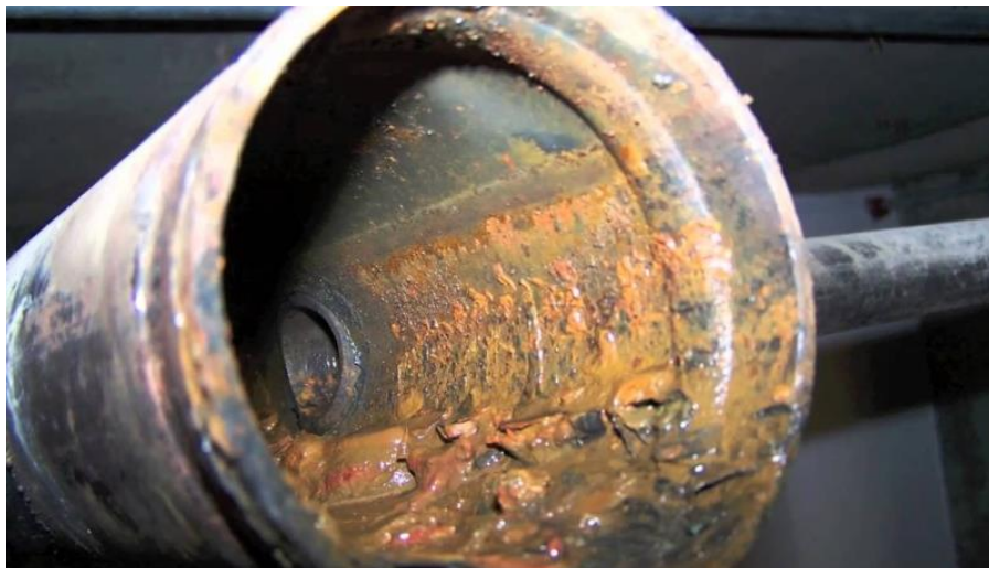
Obr. 12 Biofilm v protipožárním systému zasazeném MIC [3]
