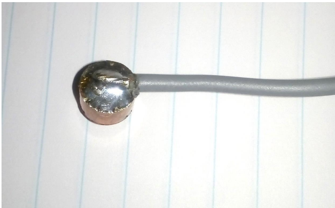
Obr. 30 Kabel připojený pájením cínovou pájkou ke vzorku z mědi
