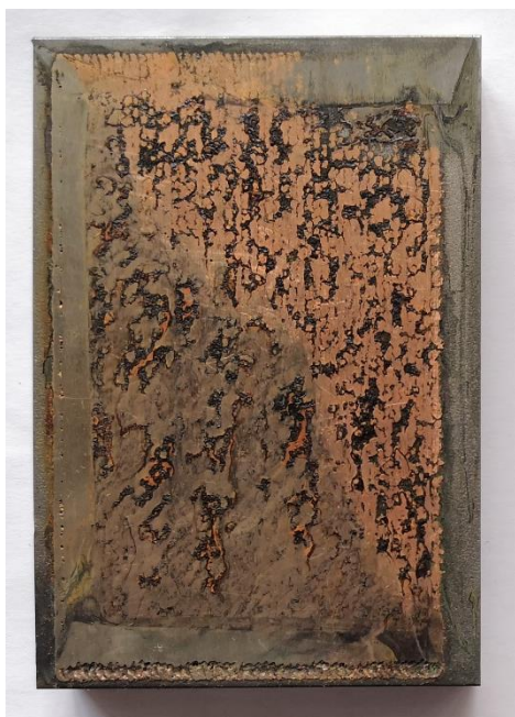
Obrázek 34 - Makrosnímek vzorku S4_10c po provedení korozní zkoušky v solné mlze
