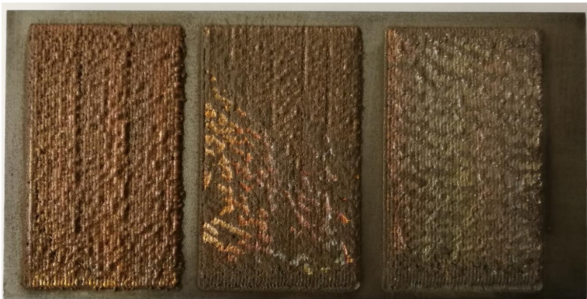
Obrázek 16 - Laserový návar měď - čedič, vlevo vzorek č. S3_5c, uprostřed vzorek č. S3_10c, vpravo vzorek č. S3_15c
