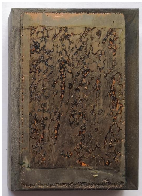
Obrázek 35 - Makrosnímek vzorku S4_15c po provedení korozní zkoušky v solné mlze
