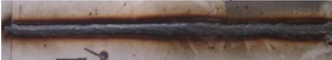
Obr. 36 – Pohled na líc svaru pro kontrolní vzorek s použitím směsi plynů – ochranný plyn - 78% Ar + 20 % He + 2 % CO 2 / formovací plyn 100 % N 2
