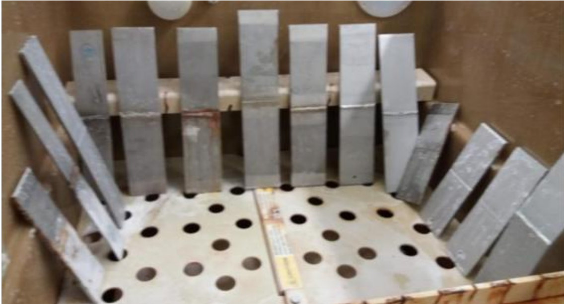
Obr. 78 – Rozložení testovaných vzorku v korozní komoře
