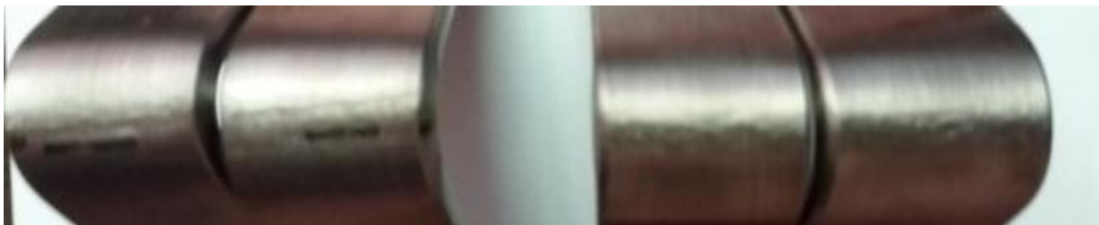
Obr. 57 – Ohnuté zkušeni vzorky kontrolního spoje vzorku č. 2
