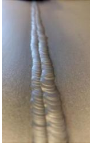
Obr. 23 – Detail na líc svaru pro metodu 141
