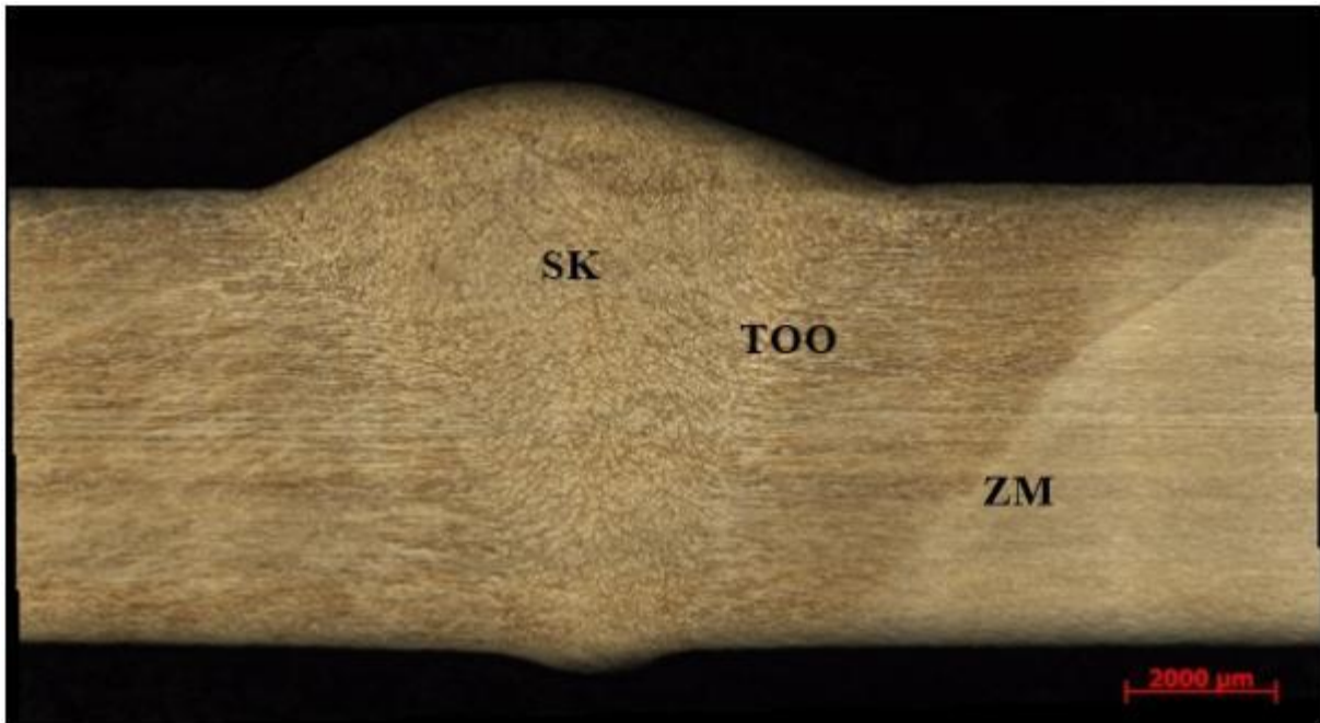
Obr. 69 – Pozorování makrostruktury vzorku č. 1
