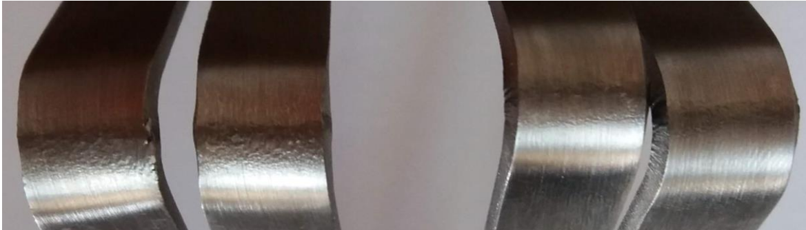
Obr. 61 – Ohnuté zkušební vzorky kontrolního spoje vzorku č. 7
