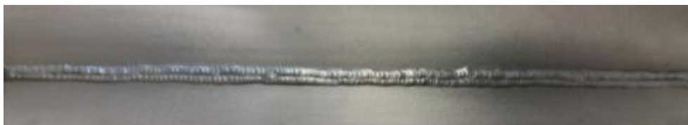
Obr. 21 – Kontrolní vzorek z lící strany svaru pro metodu 141
