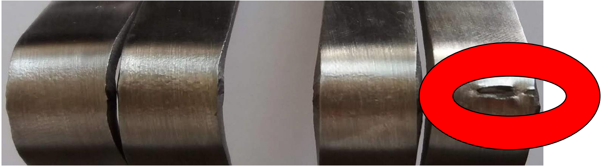
Obr. 60 – Ohnuté zkušební vzorky kontrolního spoje vzorku č. 6
