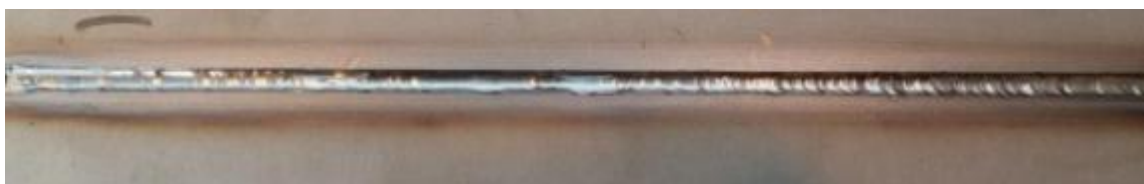
Obr. 25 – Drážka svaru připravena pro metodu 135
