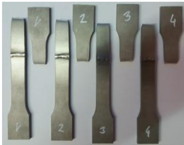
Obr. 44 – Přetržené vzorky kontrolního spoje č. 2
