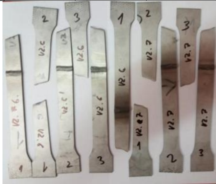
Obr. 48 – Přetržené vzorky kontrolního spoju č. 6 a 7
