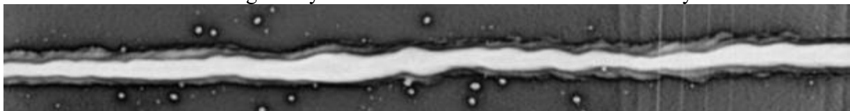
Obr. 39 – radiografický snímek kontrolního vzorku č. 6 – metody 135
