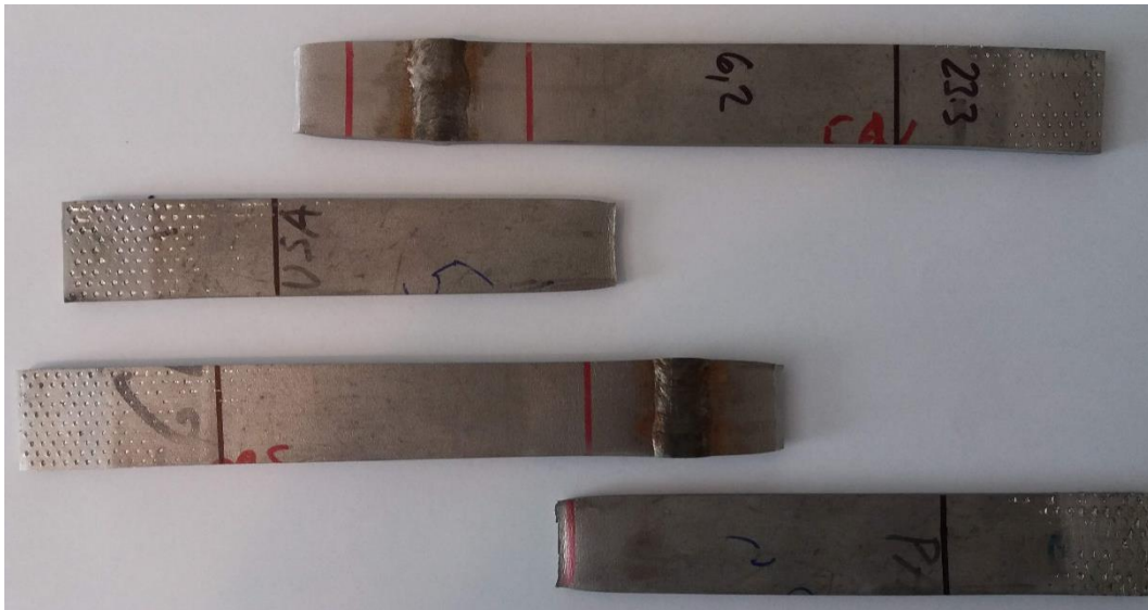
Obr. 83 – Přetržené vzorky kontrolního spoje č. 5a
