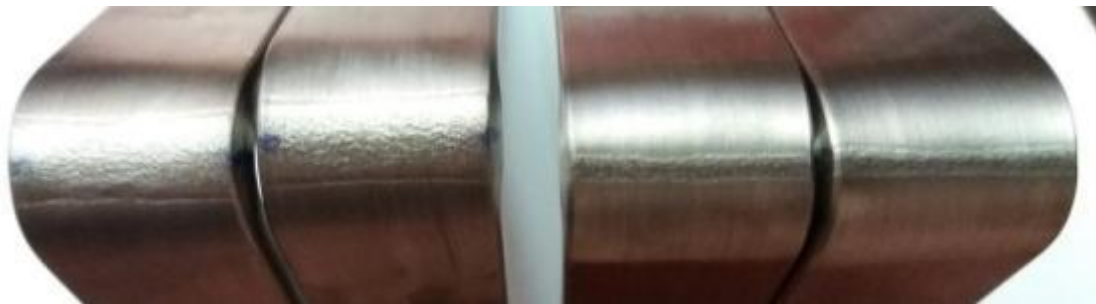
Obr. 56 – Ohnuté zkušeni vzorky kontrolního spoje vzorku č. 1
