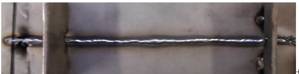
Obr. 33 – Pohled na kořen svaru pro kontrolní vzorek s použitím směsi plynů – ochranný plyn -78% Ar + 20 % He + 2 % CO 2 / formovací plyn 78% Ar + 20 % He + 2 % CO 2
