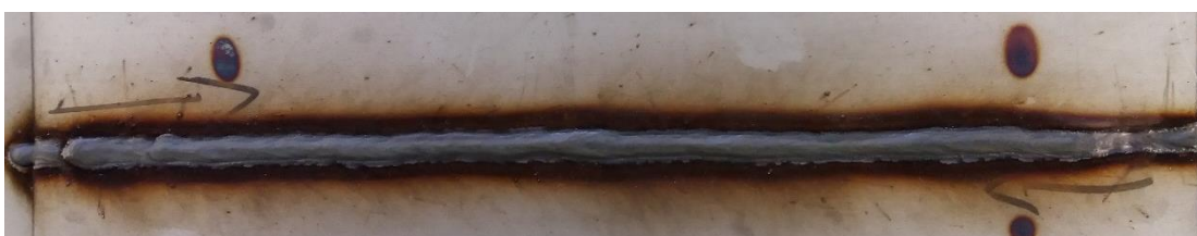
Obr. 33 – Pohled na kořen svaru pro kontrolní vzorek s použitím směsi plynů – ochranný plyn -78% Ar + 20 % He + 2 % CO 2 / formovací plyn 78% Ar + 20 % He + 2 % CO 2
