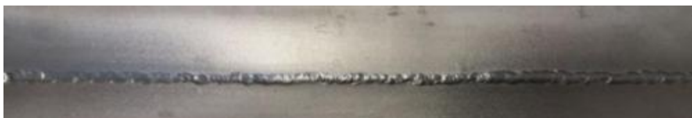
Obr. 22 – Kontrolní vzorek ze strany kořene pro metodu 141
