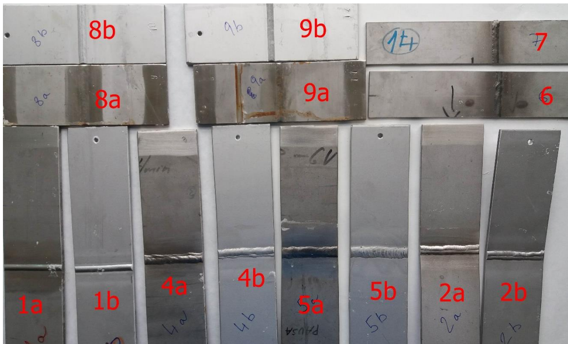
Obr. 79 – Zdokumentované vzorky po 240 hodinách testu – strana líce svaru
