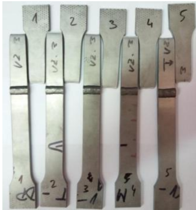
Obr. 46 – Přetržené vzorky kontrolního spoje č. 3
