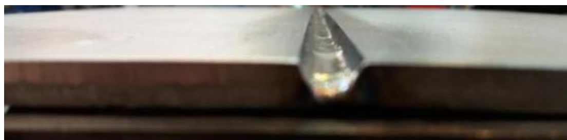
Obr. 26 – Plech připravený pro svařování metodou 135 - pohled do úkosu
