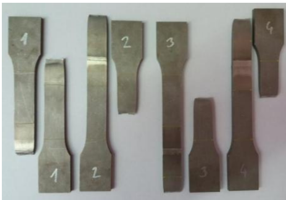
Obr. 42 – Přetržené vzorky kontrolního spoje č. 1
