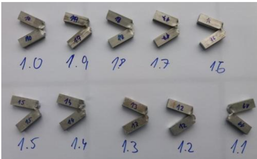
Obr. 51 – Přeražené vzorky kontrolního spoje č. 1
