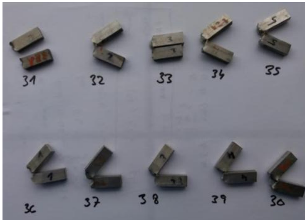
Obr. 53 – Přeražené vzorky kontrolního spoje č. 3
