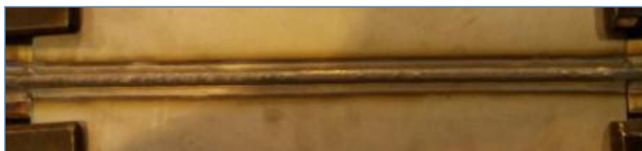
Obr. 17 – Kontrolní vzorek z lící strany svaru pro metodu 15
