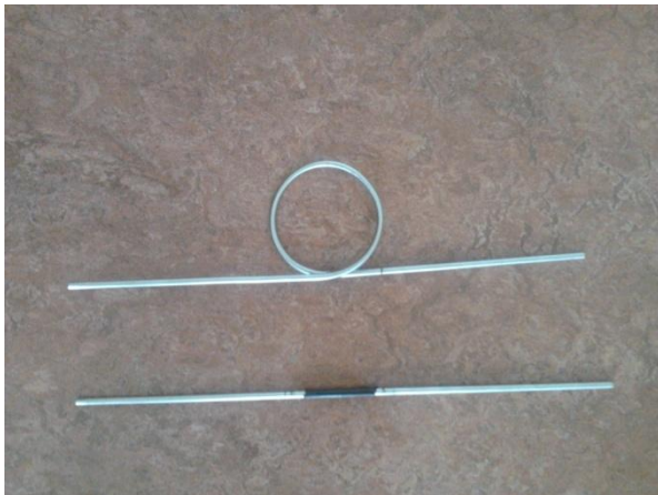
Obr. P1.6: Odběrové trasy používané při měření – smyčka, 30 cm rameno
