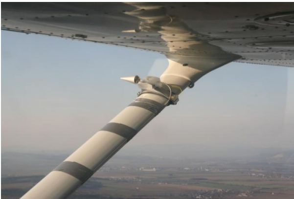
Obr. P5.2: Odběrová sonda umístěná pod křídlem letadla [ČHMÚ]
