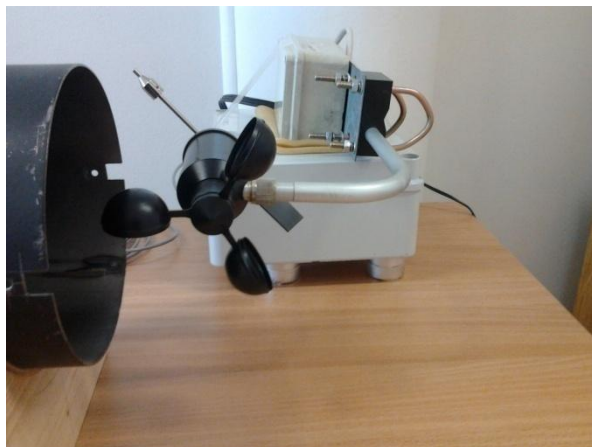
Obr. P1.2: Cejchování regulace rychlosti proudění vzduchu anemometrem
