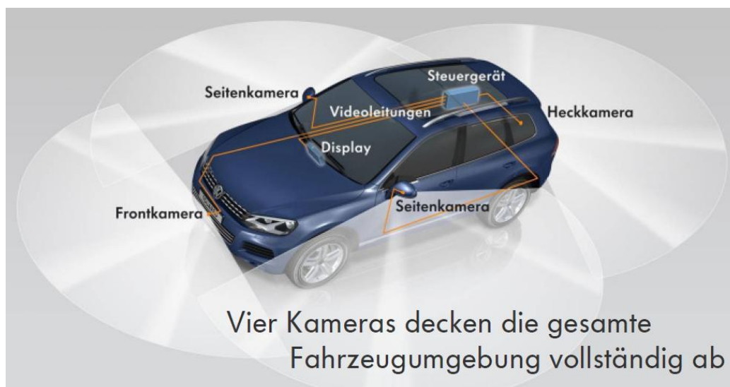
Obr. 37 – Rozmístění kamer na voze VW Touareg [7]
