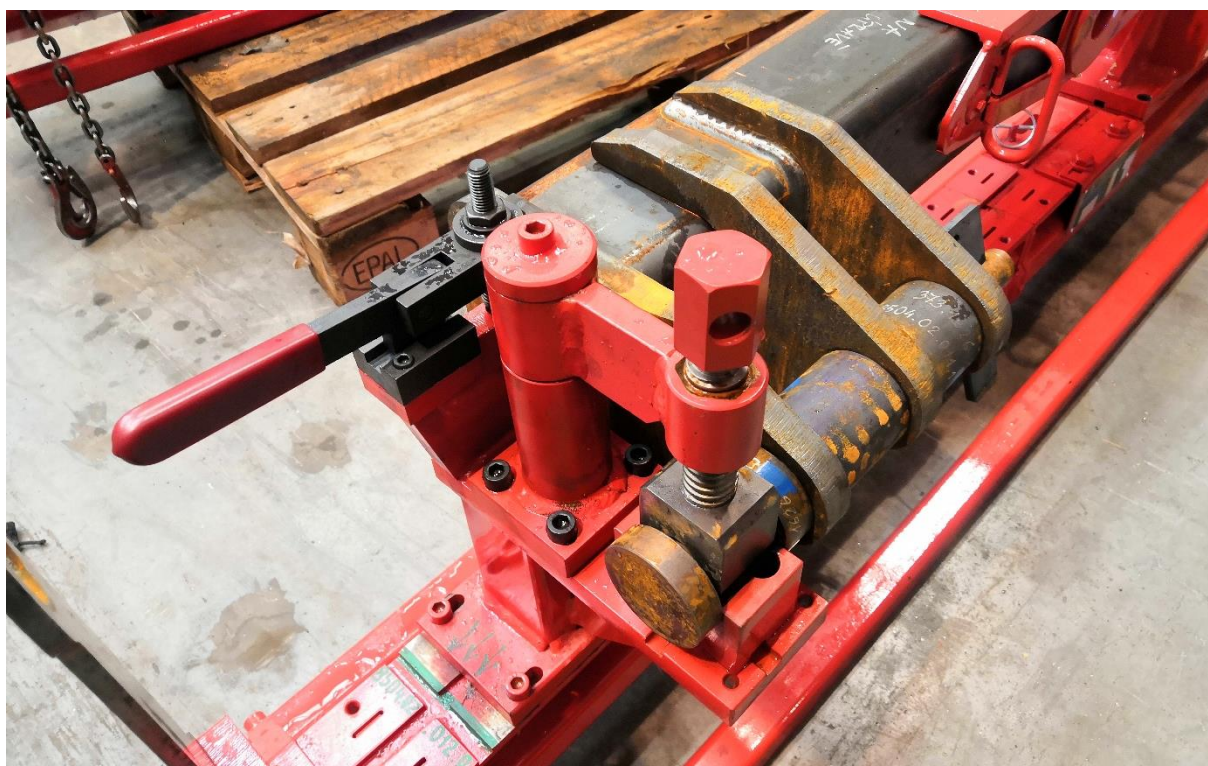
Obr. 5 Detail upravené konzole na dovařovacím přípraku
