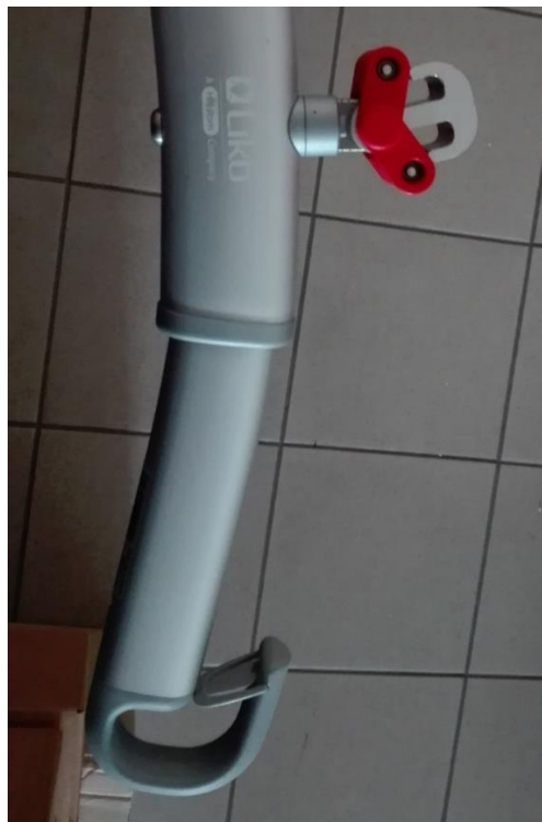
Obrázek 24 - zámek kotvy k rámu (nahore) a zámek popruhů na kotvě (dole)
