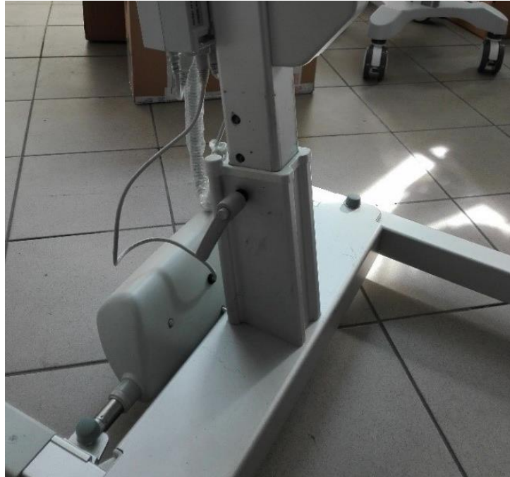
Obrázek 22 - pojistný kolík pro polohování výšky rámu
