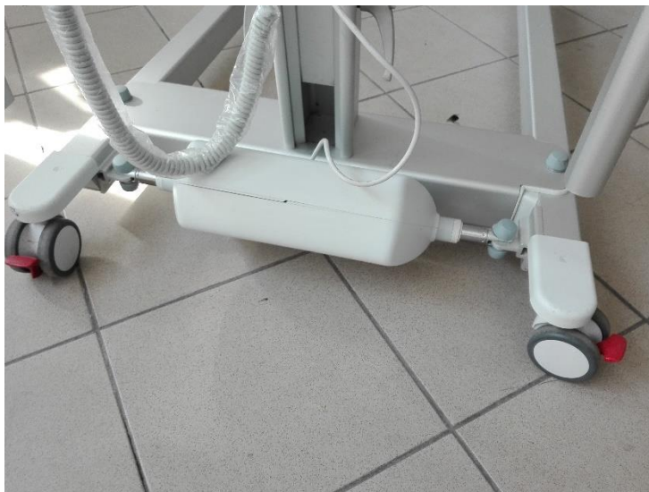
Obrázek20 - nastavitelný úhel bočnic za pomoci pístů
