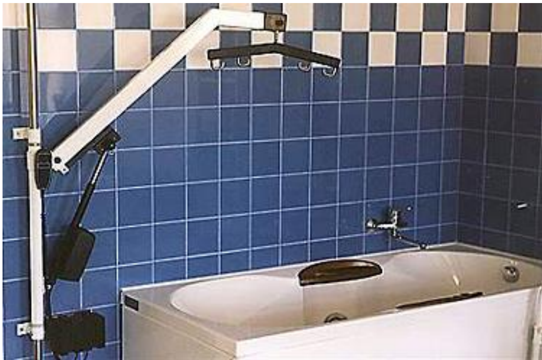
Obrázek 16 - nástěnné zařízení s pevným ramenem [9]
