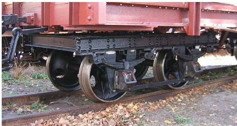
Obr. 12: Podvozek s rozsochovým vedením (KŘD)
