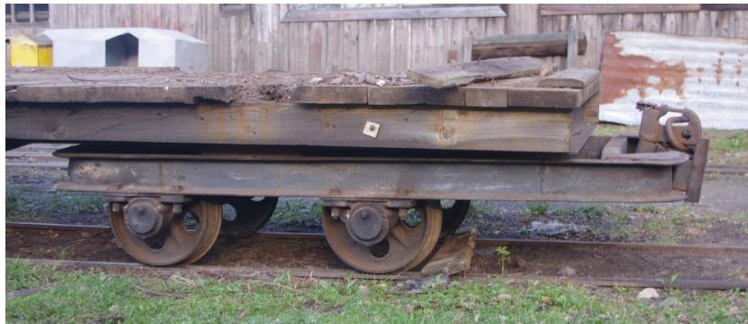
Obr. 9: Nevypružený otočný podvozek s oválným rámem
