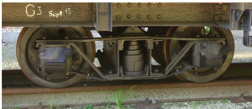
Obr. 11: Diamond Archbar z dráhy WEM (Německo)
