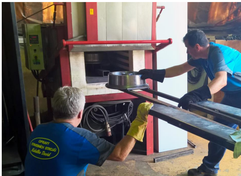
Obr. 52: Zavážení kola do pece
