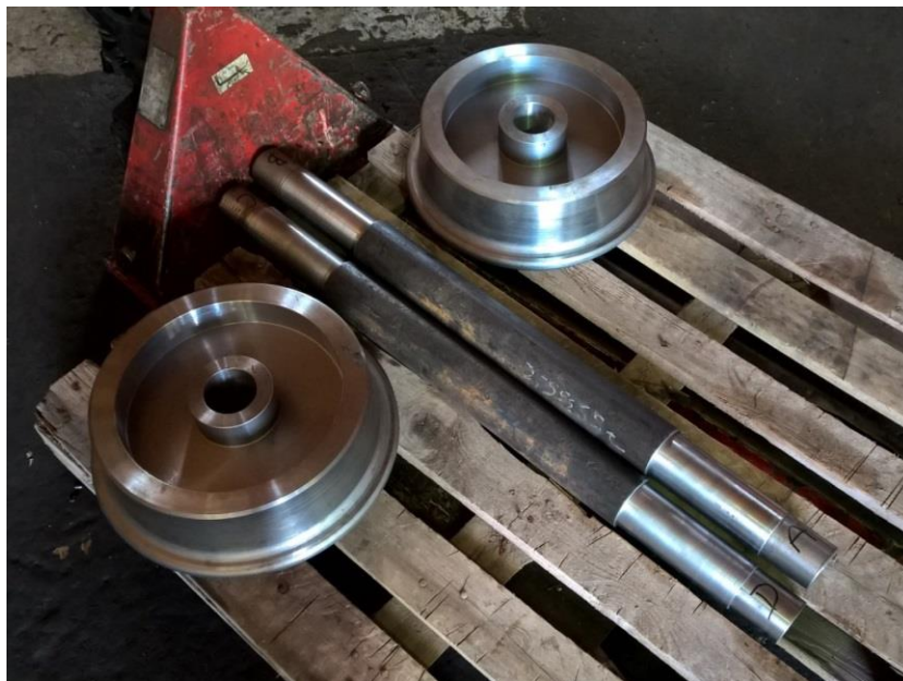
Obr. 16: Pohled na vyrobená kola s nápravami
