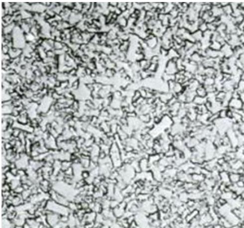
Obrázek 8: Mikrostruktura 97WC-3Co (středně velká zrna) [3]
