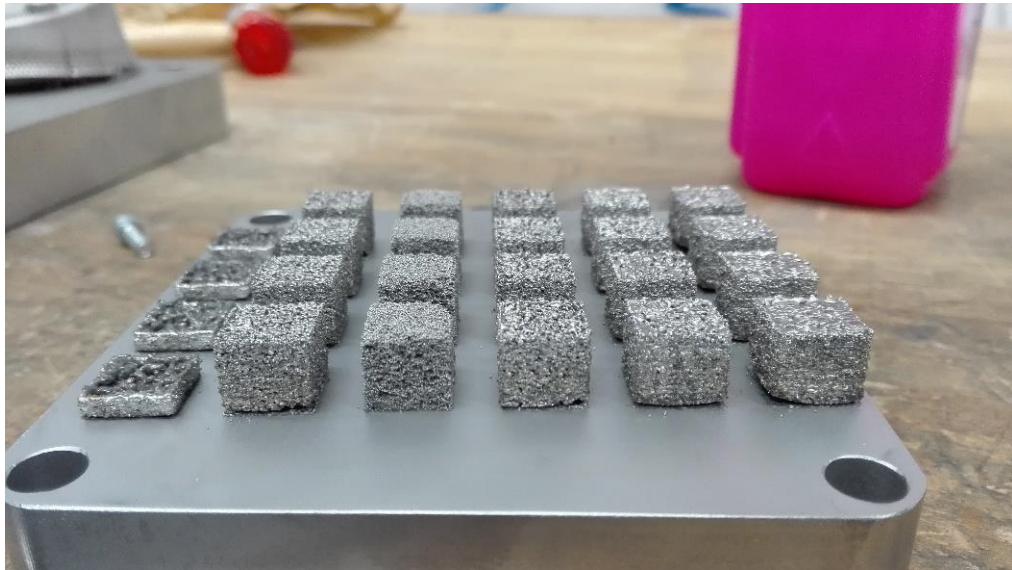
Obrázek 10: Stavěcí deska s vytištěnými vzorky
