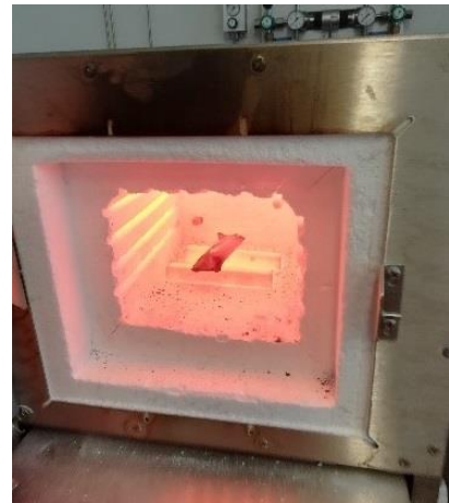
Obrázek 15: Uložení vzorků v žhací peci
