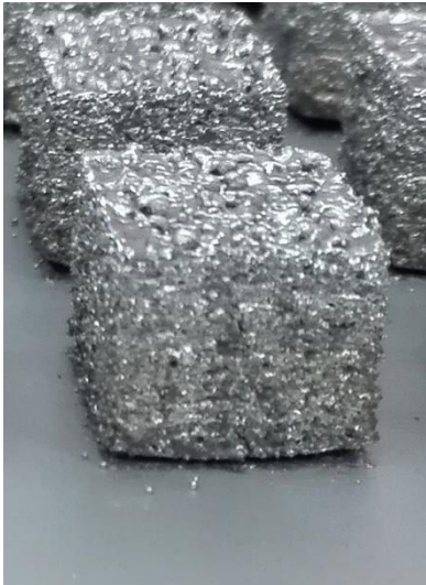
Obrázek 21: Delaminace spodních vrstev vzorku od stavěcí desky
