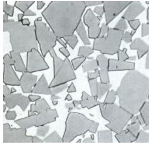
Obrázek 9: Mikrostruktura 85WC-15Co (hrubá zrna) [3]
