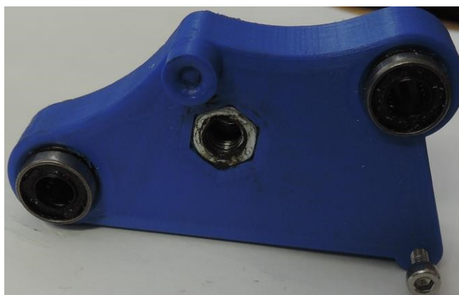
Obrázek 5.6 – Nalisovaná lineární ložiska do pohyblivé části
