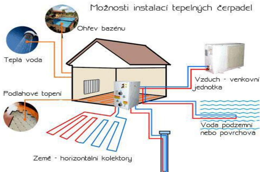
Obr. 8 Instalace tepelných čerpadel [10]
