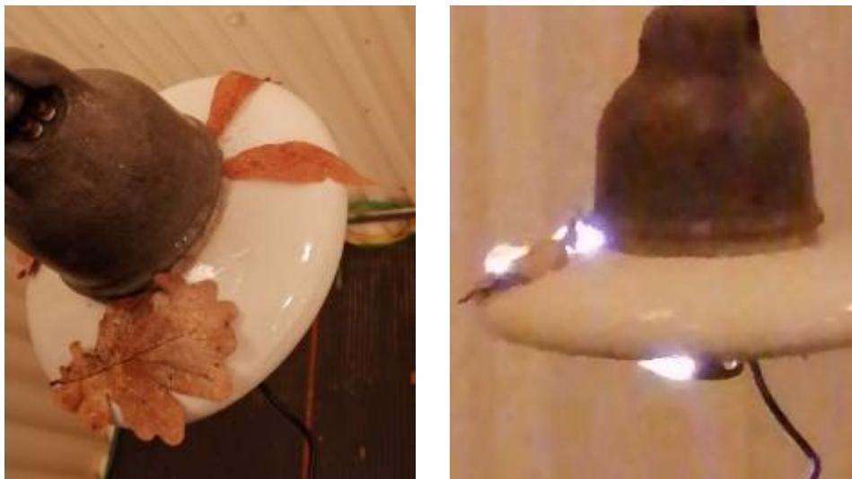
Obrázek 18: Podzimní izolátor, přeskok po dubovém listu
