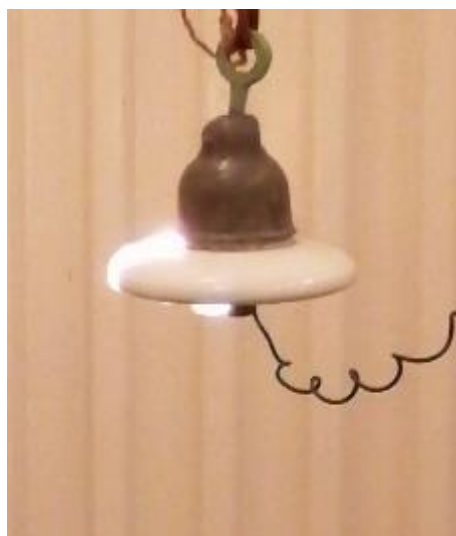
Obrázek 14: Přeskok po vlhkém povrchu
