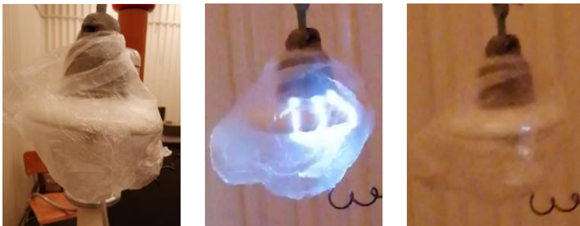
Obrázek 19: Izolátor obklopený sáčkem, přeskok po povrchu, zapálení sáčku
