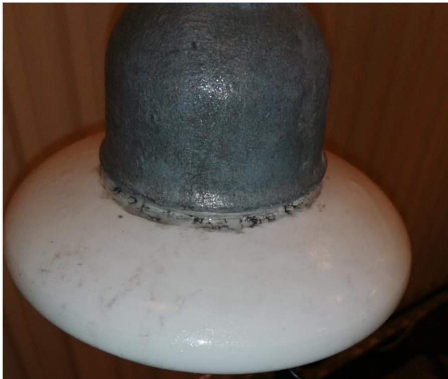
Přílohový obrázek 1: Stopy uhlíku u čepičky
