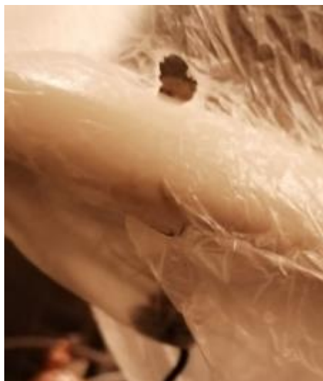
Obrázek 20: Propálení v místě největšího přilnutí
