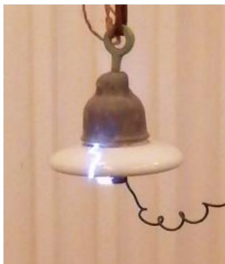
Obrázek 13: Přeskok po suchém a čistém povrchu
