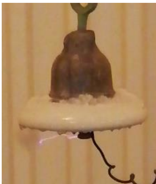
Obrázek 17: Výboj na padajícím sněhu
