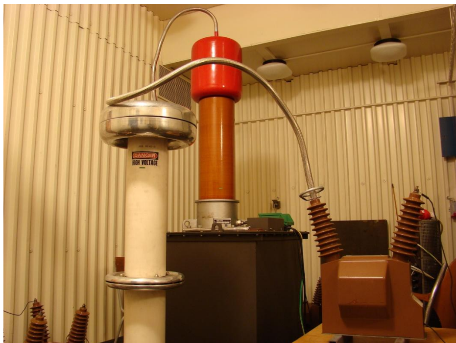
Obr. 23: Měření částečných výbojů
