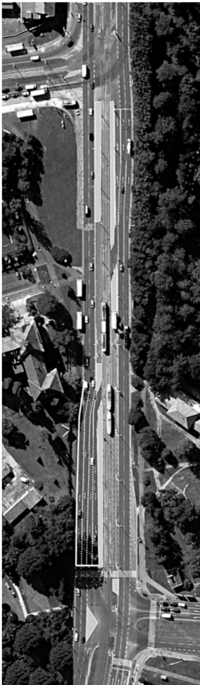
Fotomontáž zachycuje stav po provedené rekonstrukci. Ač je to nemyšliteľné, vodorovné značení není chybně zaznamenané, jeho průběh odpovídá realitě. Zastávka ve směru z centra je odsunutá blíže k centru (směrem vpravo), před zastávkami vznikly výjezdové komunikace pro autobus. Křižovatka s ulicí Na Chmelnici získala druhý levý odbočovací pruh a byla kanalizována pomocí trojúhelníkového ostrůvku v přímé větvi. Zdroj: Ortofotomapa
