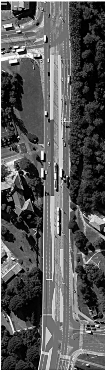
Fotomontáž zachycuje stav po provedené rekonstrukci. Ač je to nemyšliteľné, vodorovné značení není chybně zaznamenané, jeho průběh odpovídá realitě. Zastávka ve směru z centra je odsunutá blíže k centru (směrem vpravo), před zastávkami vznikly výjezdové komunikace pro autobus. Křižovatka s ulicí Na Chmelnici získala druhý levý odbočovací pruh a byla kanalizována pomocí trojúhelníkového ostrůvku v přímé větvi. Zdroj: Ortofotomapa
