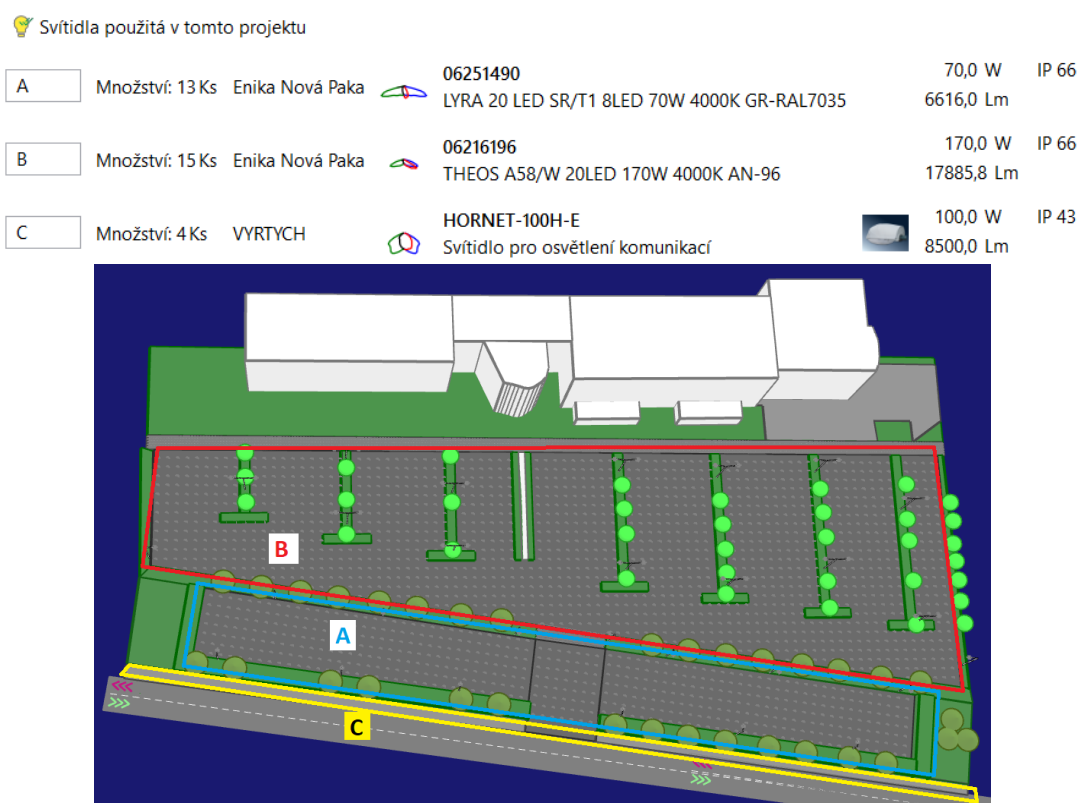
Obrázek 49 Přehled parametrů zvolených světelných zdrojů a svítidel a jejich umístění v modelu
