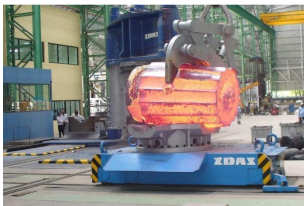
Obrázek 11-Typy samosvorných kovářských kleští vlevo, automatické kovářské kleště od firmy ŽDAS QMJV vpravo [3] [1]
