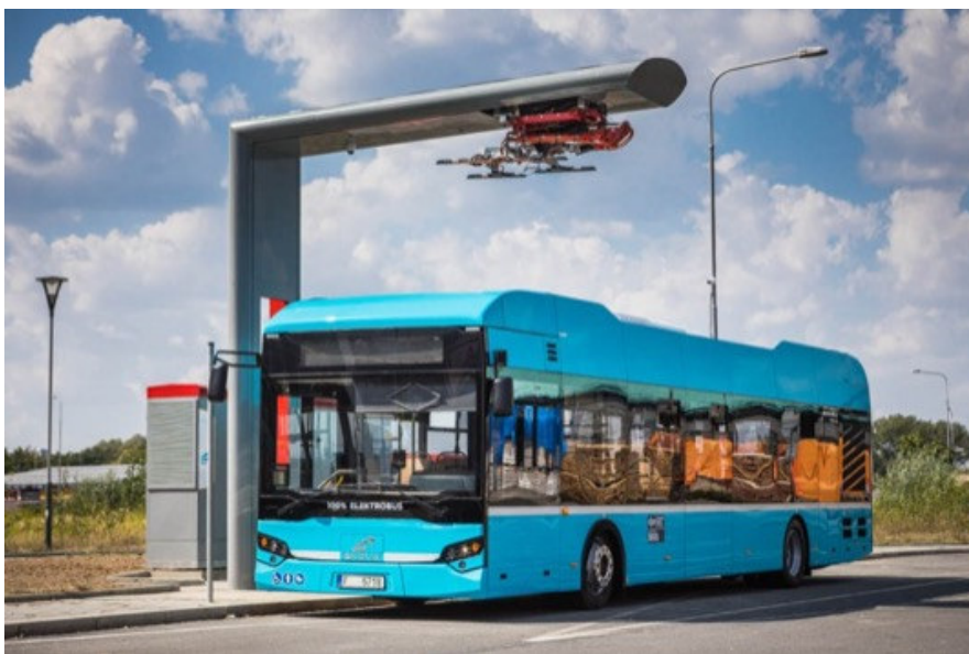
Obrázek 7 - Elektrický autobus u "pantografové" nabíječky [34]
