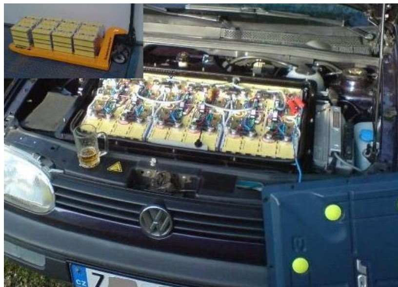
Obrázek 8 - Umístění akumulátorů pod kapotou elektromobilu [7]
