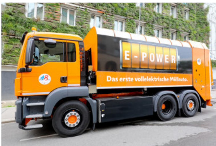
Obrázek 3 - Elektrický popelářský vůz jezdící v ulicích Vídně [27]
