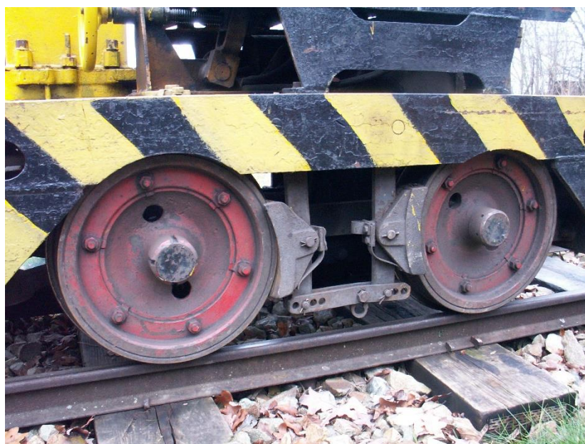
Obrázek 3 – Lokomotiva ALD-2 (Starý Plzenec) – Detail brzdy
