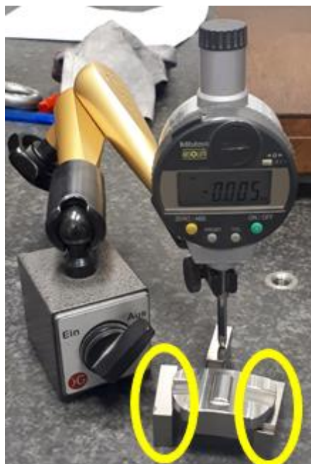
Obrázek 5.3 - Vyznačení problému se stabilitou současného přípravku
