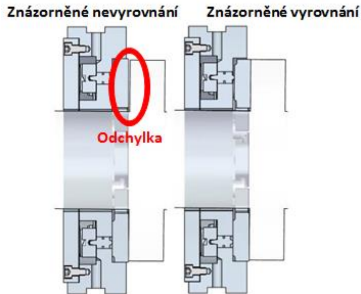
Obrázek 2.2 - Znázornění samovyrovnávacího principu [3]
