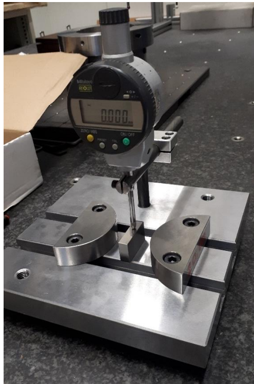
Obrázek 4.23 – Nastavení nulové polohy pomocí koncových měrek
