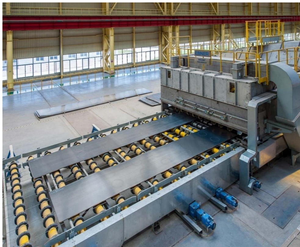
Obr. 4-5: Kontinuální pec pro ohřev plechů, HICON® roller-hearth furnace od společnosti EBNER Industrieofenbau GmbH [11]
