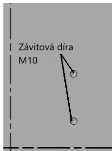
Obr. 7-11: Detail závitových děr na spodní ploše tažnice
