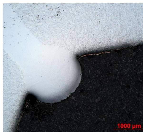
Obr. 45: Akcelerovaný Strauss test - vzorek mořený D-Leskem, zvětšení 2,5x (2)
