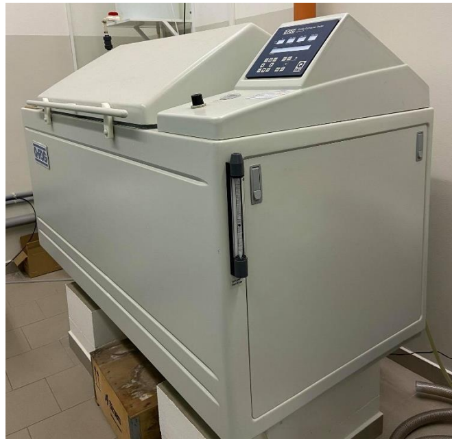
Obr. 16: Cyklická korozní komora Q-FOG – CCT 1100
