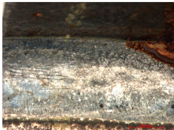
Obr. 30: Stereomikroskop, zvětšení 1x - vzorek mořen D-Leskem
