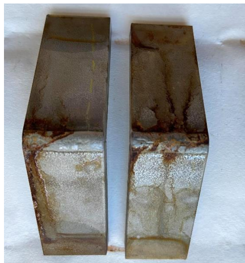
Obr. 25: Po korozním testu – vzorky mořeny D-Leskem
