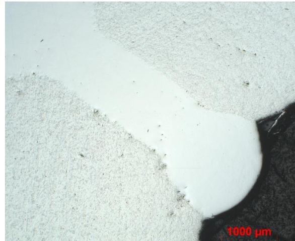
Obr. 34: Mikrostruktura svaru vzorku mořené D-Leskem
