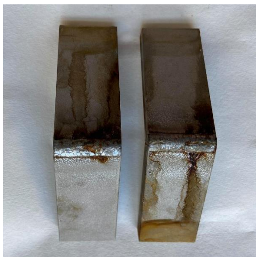
Obr. 26: Po korozním testu - vzorky mořeny směsí HNO_3 a HF
