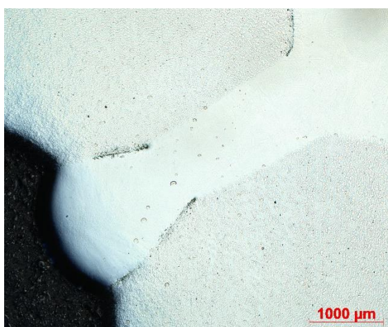
Obr. 52: Strauss test - vzorek mořený směsí HNO_3 a HF , zvětšení 2,5x
