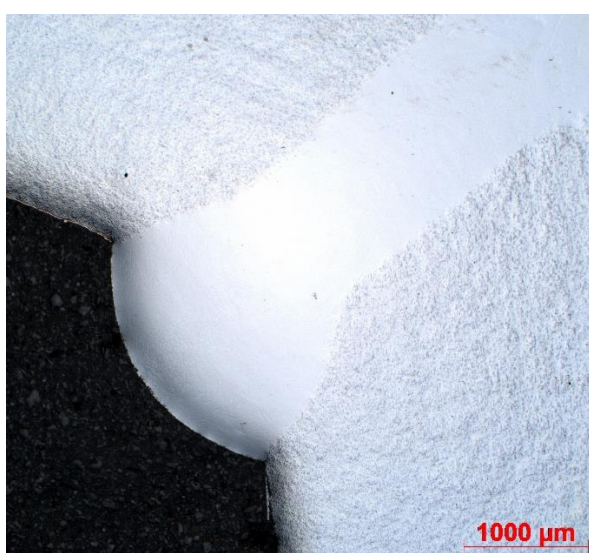
Obr. 44: Akcelerovaný Strauss test - vzorek bez moření, zvětšení 2,5x (2)
