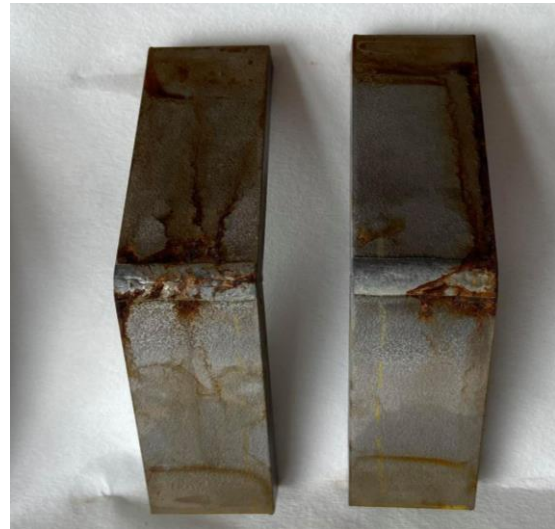
Obr. 20: Kontrola - vzorky mořené v D-Lesku
