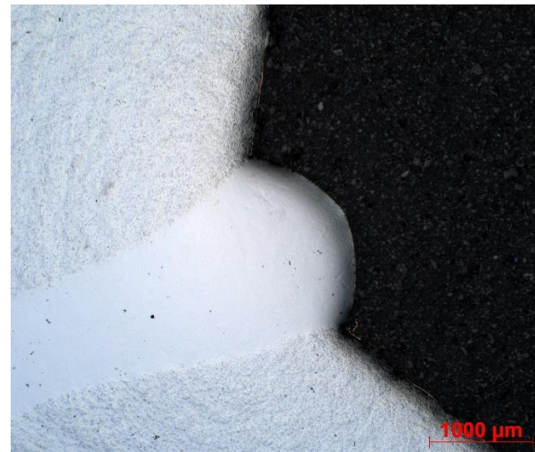
Obr. 47: Akcelerovaný Strauss test - vzorek mořený roztokem Unistrip NoCur, zvětšení 2,5x (2)
