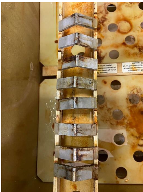
Obr. 23: Vzorky podrobeny koroznímu testu solnou mlhou - po 357 hodinách
