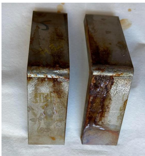
Obr. 27: Po korozní testu - vzorky mořeny roztokem Unistrip NoCur
