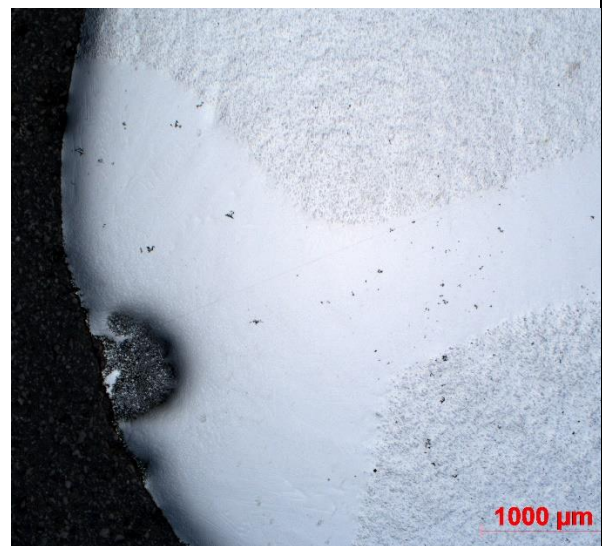
Obr. 43: Akcelerovaný Strauss test - vzorek mořený roztokem Unistrip NoCur, zvětšení 2,5x
