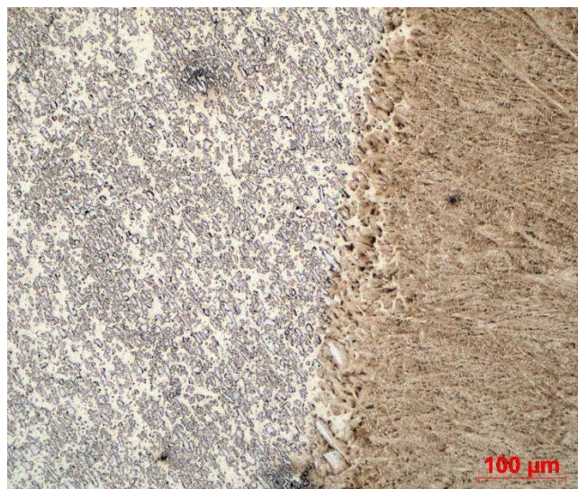
Obr. 15: Přechodová oblast svaru a základního materiálu
