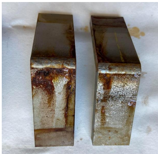
Obr. 24: Po korozním testu - nemořené vzorky
