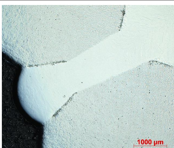
Obr. 50: Strauss test - nemořený vzorek, zvětšení 2,5x
