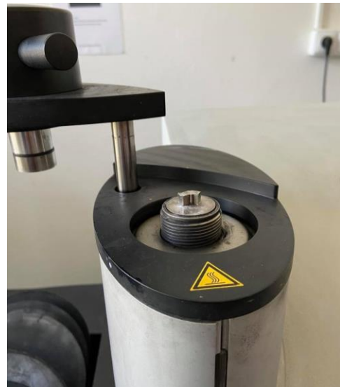
Obr. 11: Vzorek před zalisováním - Lis Struers - Citopress
