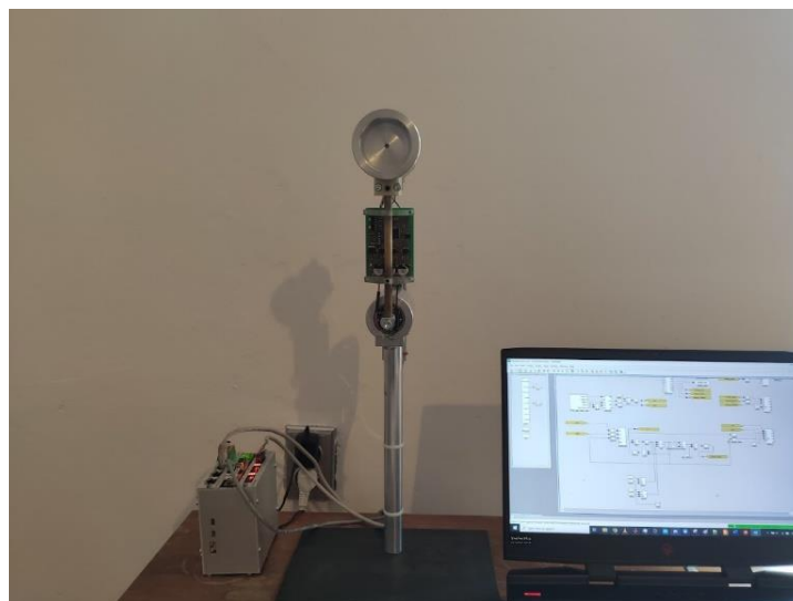
Obrázek 5.4: Kyvadlo stabilizované v horní poloze
