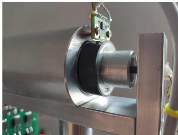
Obrázek 4.2: Detail senzoru úhlu kyvadla a kluzného kontaktu
