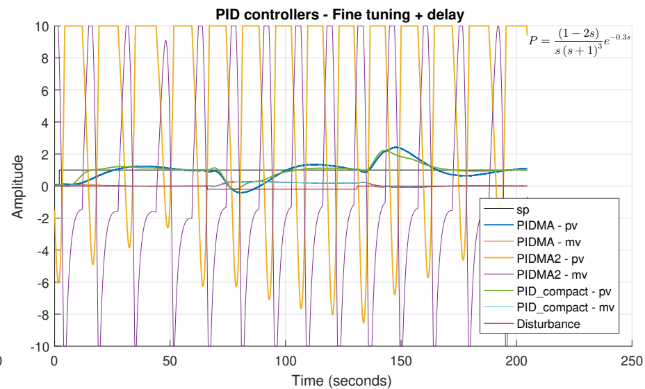
Obr. C.94: Srovnání kvality PID regulace testovaných algoritmů pro skupinu systémů A4, \alpha = 2
